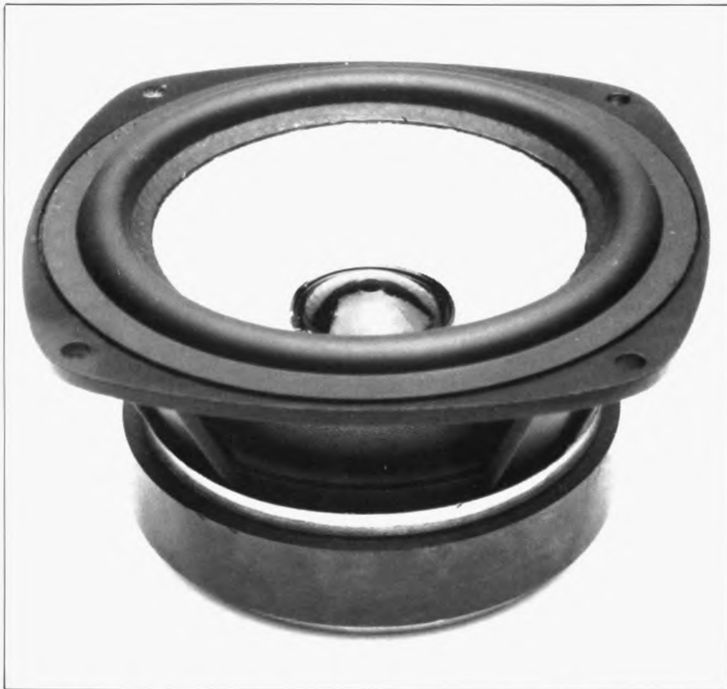
Figuur 1. Het woofertje mag aan alle kanten gezien worden. Een forse magneet zorgt voor een flinke veldsterkte in de luchtspleet. De konus is van geweven Kevlar.
