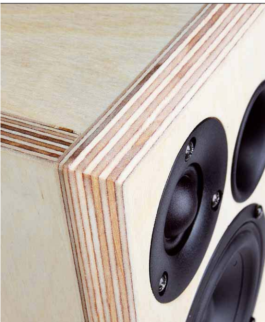
Die angefassten Kanten an der Front vereiteln eine harte Kantenbeugung und linearisieren so den Frequenzgang der Chassis in der Box
