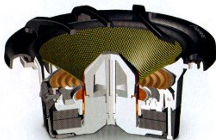
Im Schnittmodell lassen sich der Unterhangantrieb und die kupfernen Kurzschlussringe bewundern
