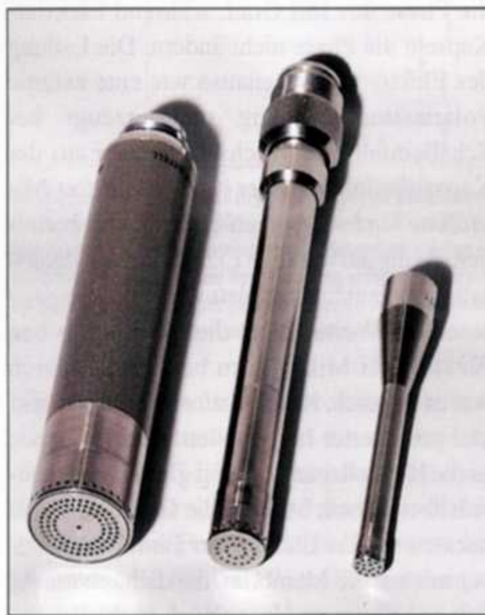
Vorverstärker/Impedanzwandler für Kondensator-Kapseln gibt es in verschiedenen Größen. Hier ein Einzoll- und ein Halbzoll-Exemplar. Rechts ist ein Adapter zu sehen, mit dem sich eine Viertelzoll-Kapsel an einem Halbzoll-Vorverstärker betreiben lässt
