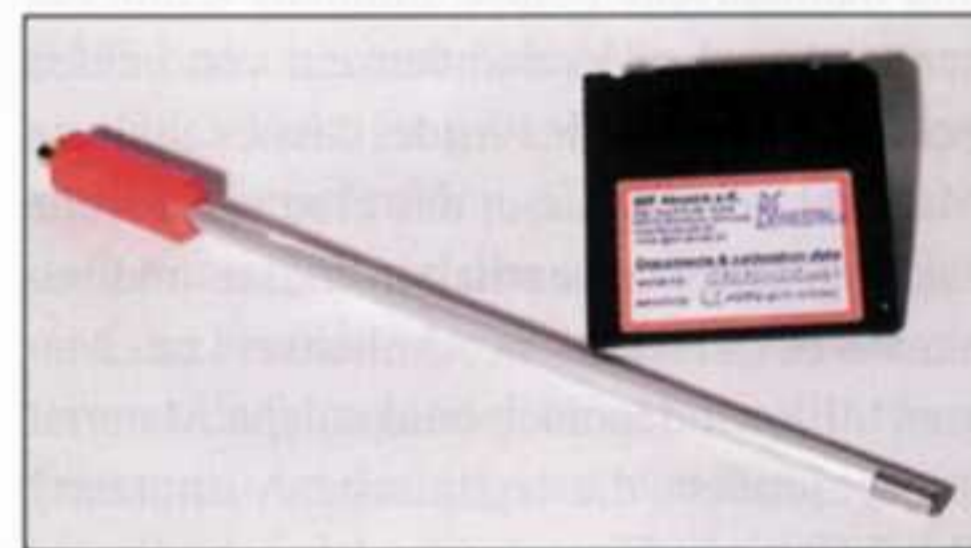
Den Vorverstärker MP-21 und das Mikrofon EMM-8 bietet der Hersteller IBF-Akustik auch als Komplett-Set an. Der Vorteil dabei: Der Verstärker ist dann genau auf die Empfindlichkeit des Mikrofons kalibriert, bei 94 dB Schalldruck leuchtet eine LED auf. So lassen sich auch ohne Kalibrator verlässliche Aussagen über den gemessenen Schalldruck machen
