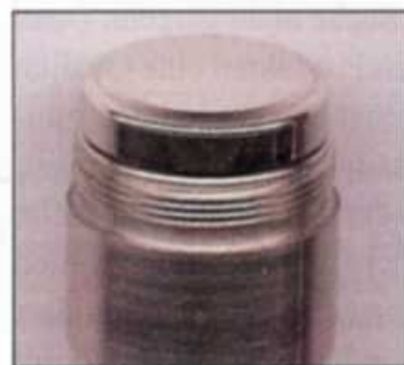
Gut zu erkennen ist hier die filigrane Membran eines Kondensatormikrofons aus Nickel
