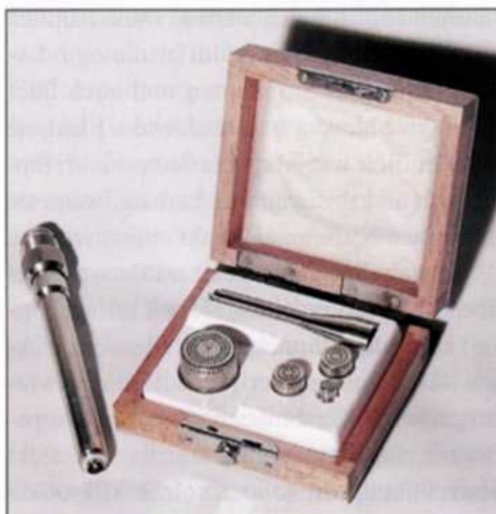
Einzoll-, Halbzoll- und Viertelzoll-Kapseln von Microtech Gefell warten auf ihren Einsatz. Daneben ein Halbzoll-Vorverstärker
