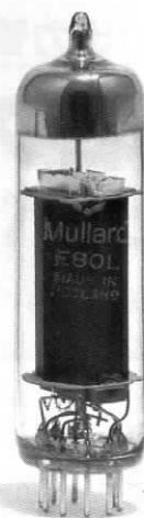
[写真2] 出力管 E80L。箱とプリントはムラードだったが、本体にはフィリップス製を示すエッチングコードがあった
