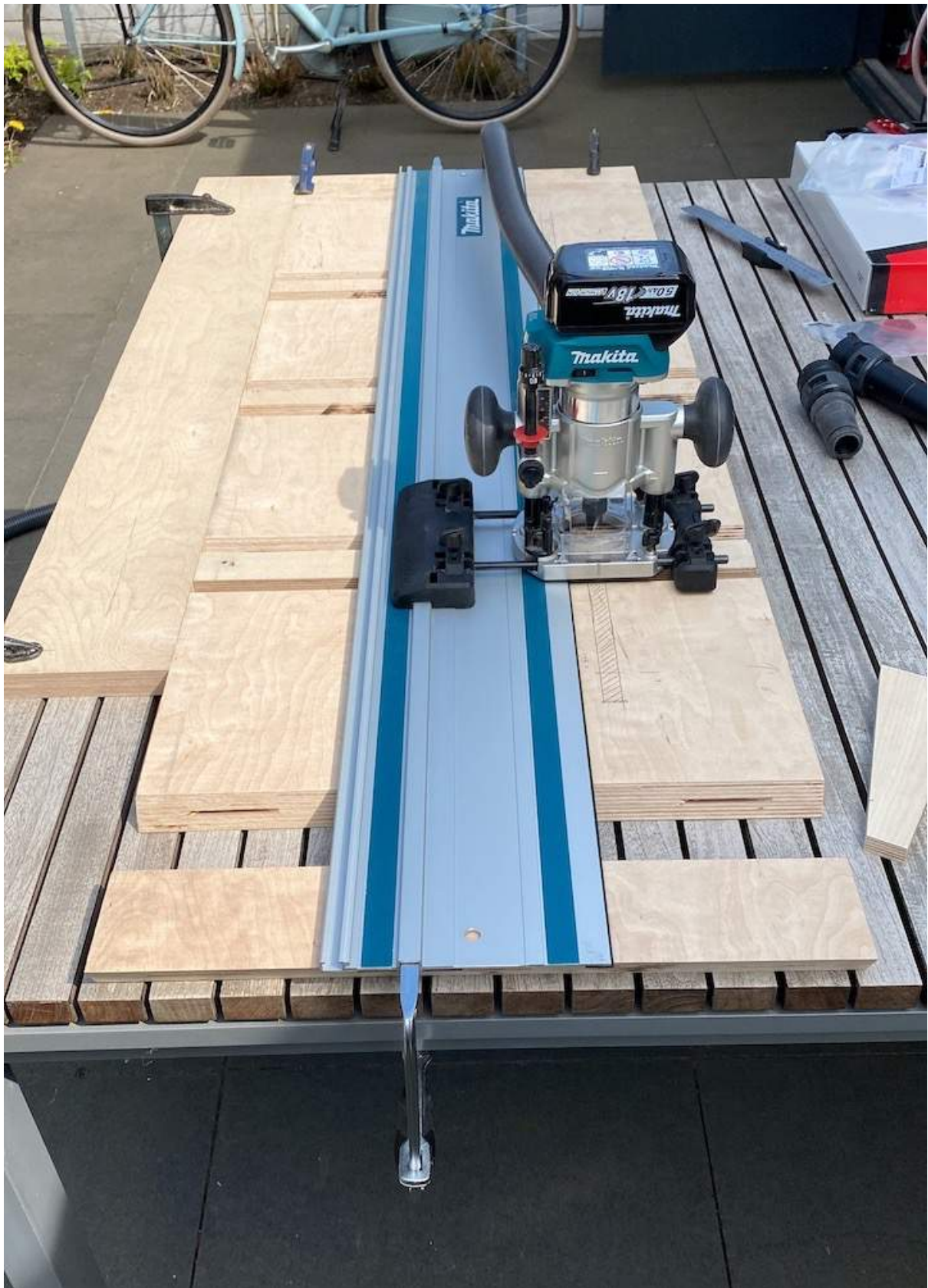
Figuur 20: Het frezen van de gleuven met geleiderail, waarbij getracht wordt dat de afstand tot boven of onderkant voor elk paneel gelijk is.
