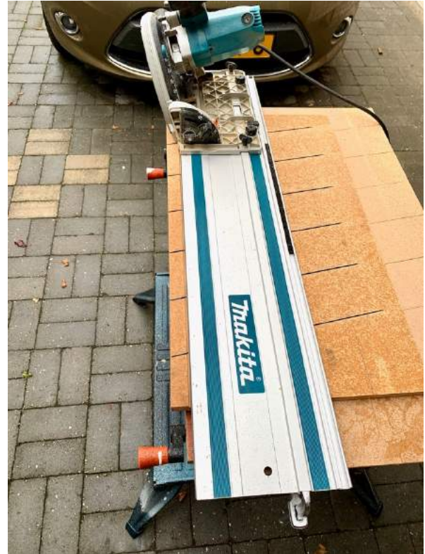
Figuur 14: het zagen van de punten van de behuizing van de BMR56.
