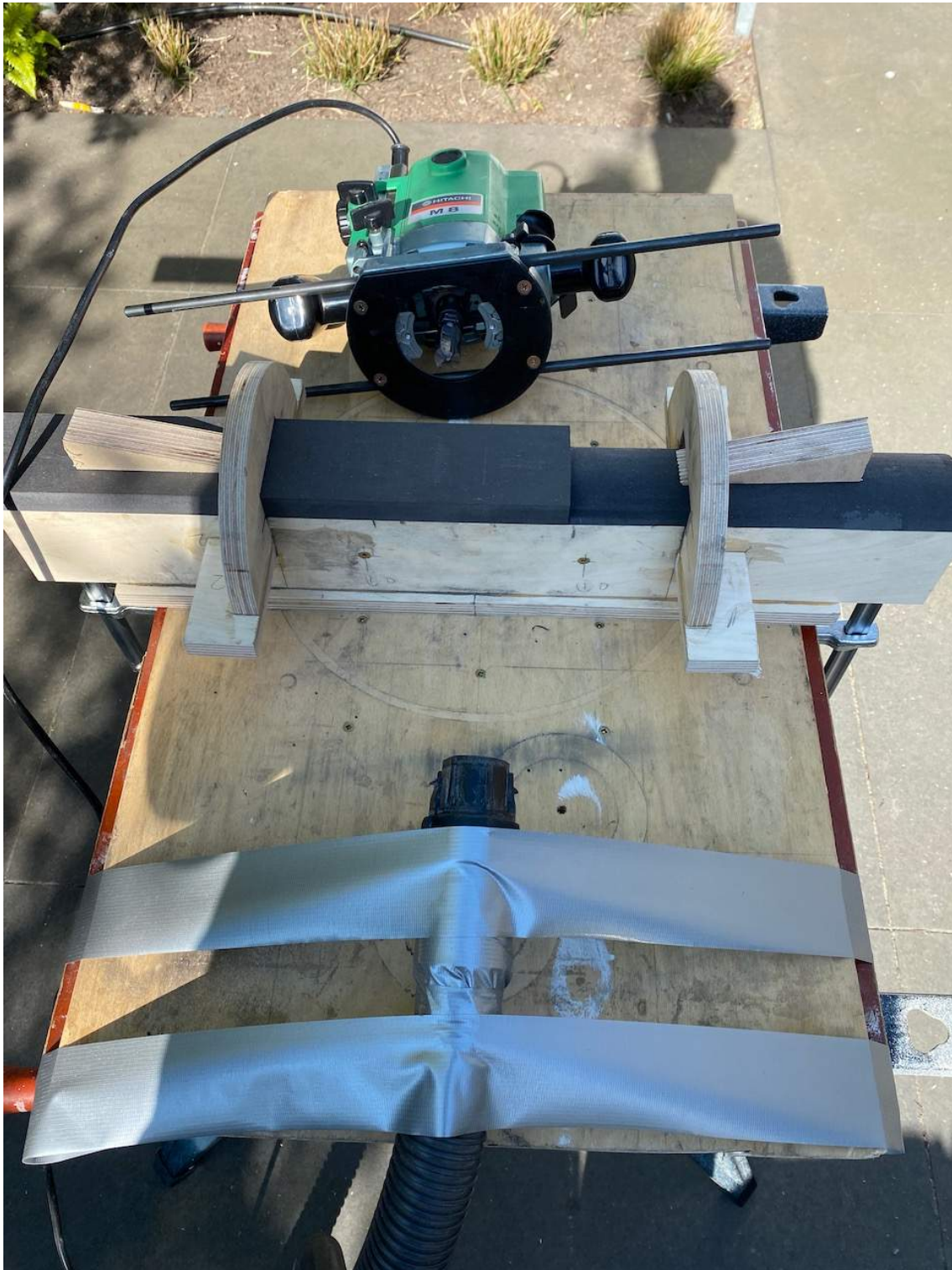
Figuur 27: Het rond frezen met mal in actie, geeft een hoop troep.
