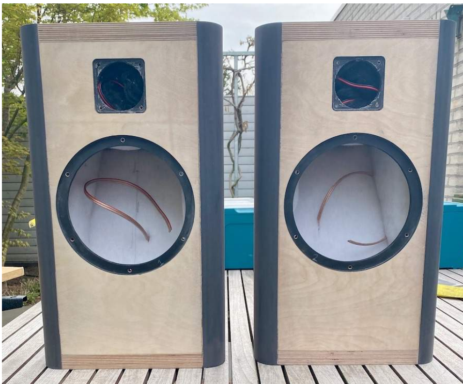
Figuur 29: na het lijmen en het afzagen van de stroken ziet het er zo uit.
