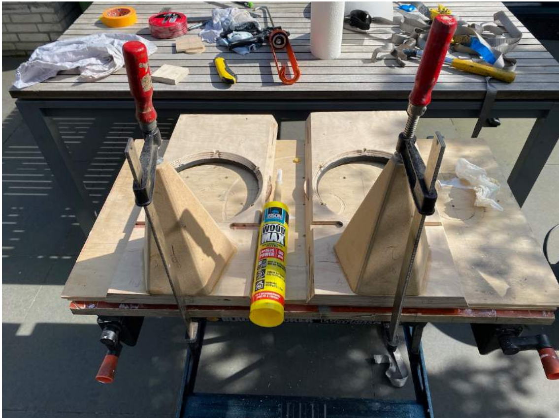
Figuur 23: Het lijmen van de BMR56 behuizing op het front.
