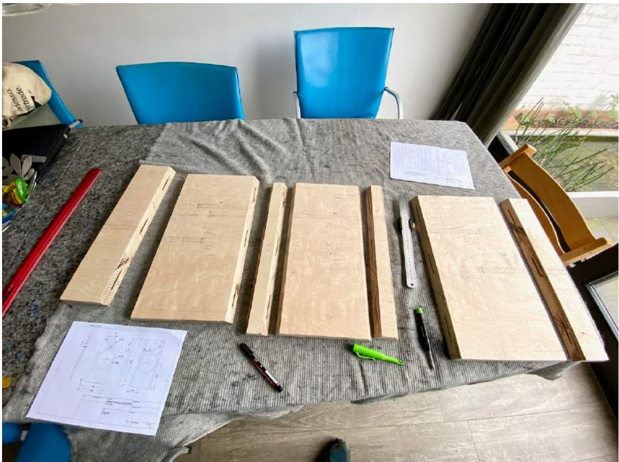
Figuur 19: Het aftekenen waar gleuven gefreesd moeten worden.
