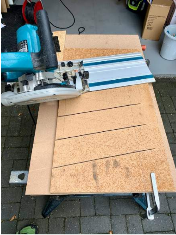
Figuur 14: het zagen van de punten van de behuizing van de BMR56.
