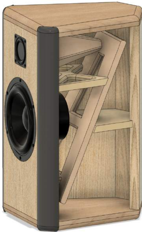
Figuur 12: Wat verschillende doorsnede tekeningen, op die manier gecontroleerd of iets niet klem komt.
