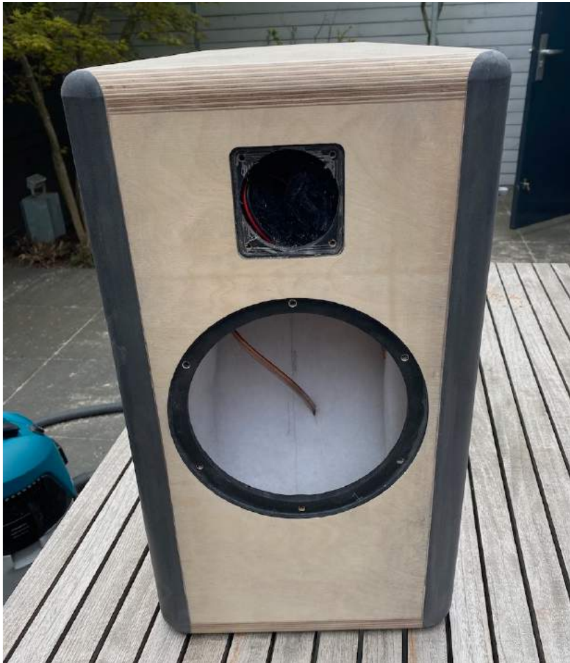
Figuur 30: Dit is resultaat na het afronden van boven en onderkant met afrondfrees.
