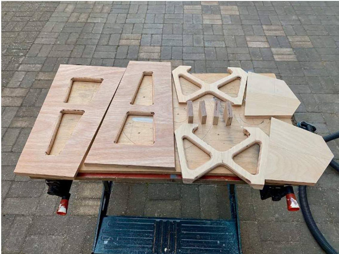
Figuur 21: Alle interne schotten bij elkaar.
