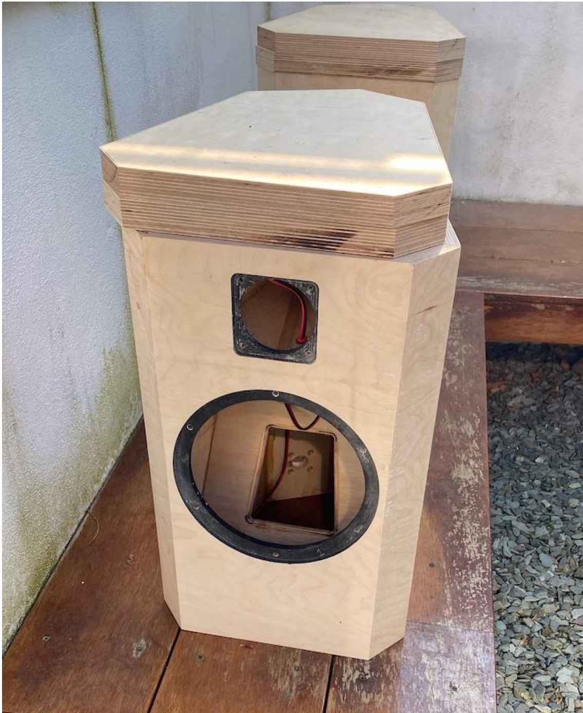
Figuur 26: Na het lijmen van de zuilen, de boven en onderkanten zijn 1-2mm te ruim gezaagd, die worden na bevestigen op maat gefreesd.
