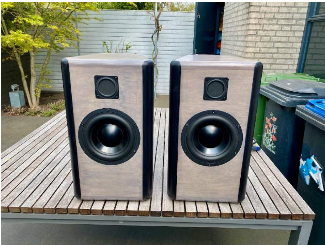
Figuur 31: Het resultaat na een paar lagen gamma grey wash beits en een laag Glitsa meubellak.
