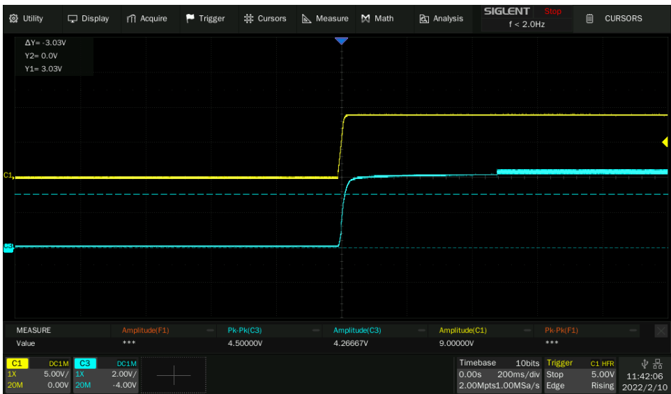
Figuur 49: Bij inschakelen uitgang zijn we bijna op halve voedingsspanning, die hier 9V is.
