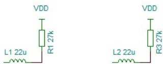
Figuur 47: De tweede poging om gedurende de mute tot halve voedingsspanning te komen.
