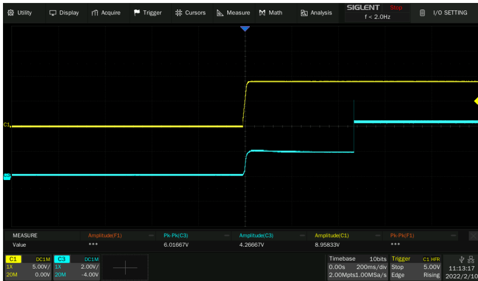
Figuur 46: Met de spanningsdeling halen we niet de halve voedingsspanning, in geel de voedingsspanning die ingeschakeld wordt en in cyan de spanning op een uitgang.
