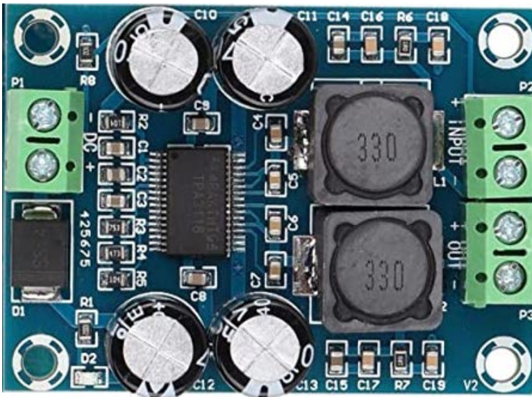
Figuur 12: Afbeelding van gebruikte TPA3118 bordje, waarbij de silk met component nummering goed te zien is.
