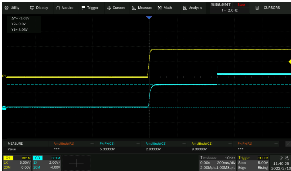
Figuur 48: Met alleen een weerstand naar VDD is er een verbetering.
