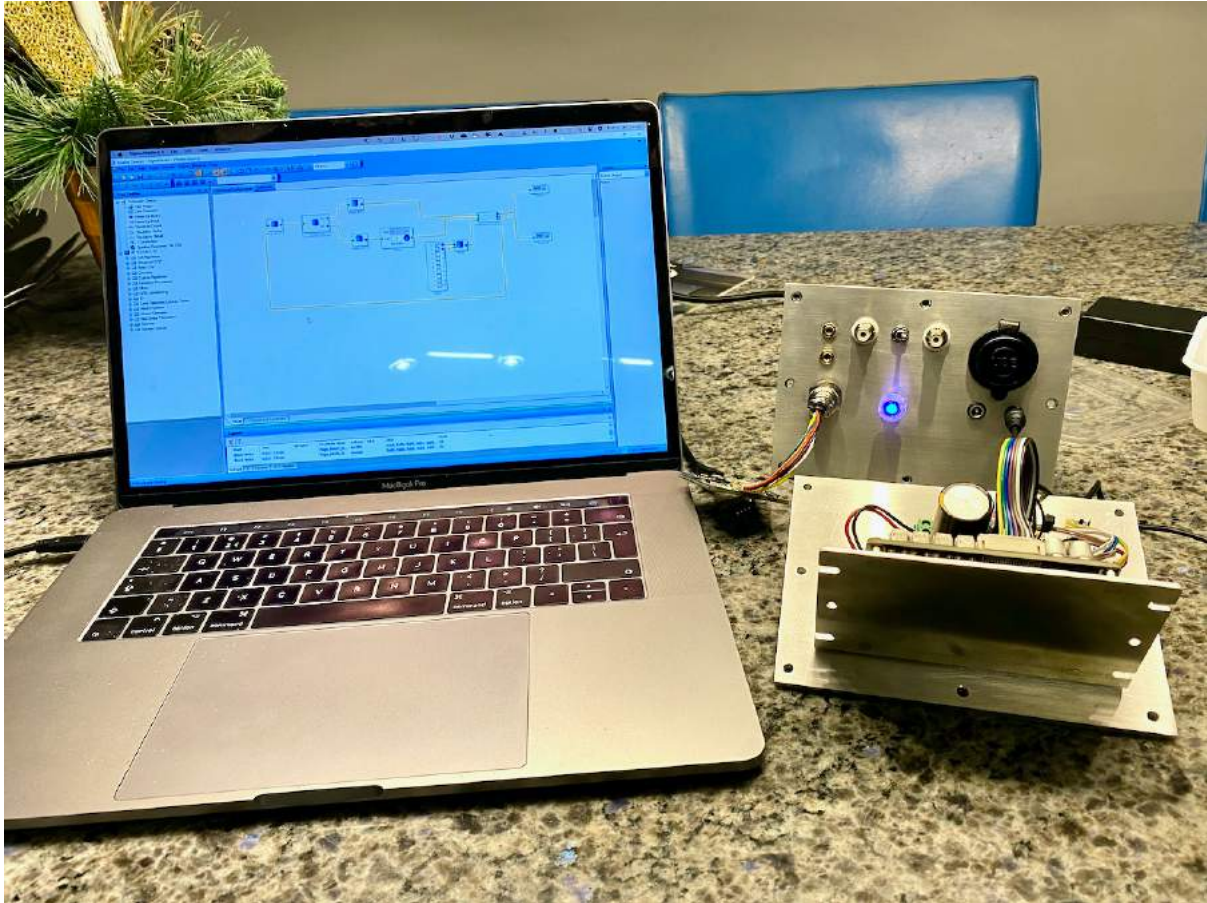
Figuur 13: Het programmeren met initieel basisprogramma waarmee ook de werking van de knop wordt gecontroleerd.
