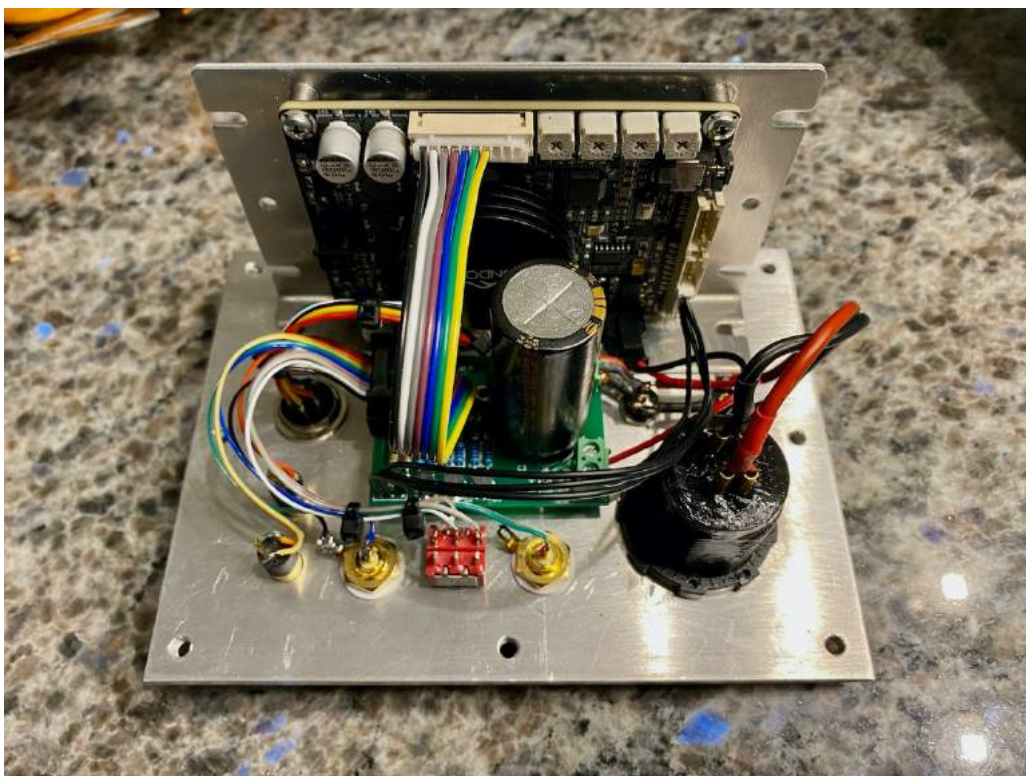
Figuur 12: Zelfde voor de andere module, hier met USB-voedingsuitgang.
