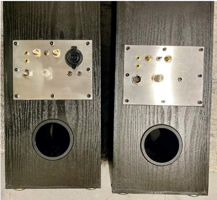
Figuur 14: De "plate amps" toegepast in bestaande speakers die een opknop beurt hebben gekregen.
