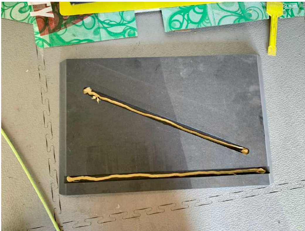
Figuur 56 Een strook lijm wordt aangebracht in de sleuven van de rechter zijkant. Deze wordt vervolgens aangebracht en met spanband naar elkaar toe getrokken.
