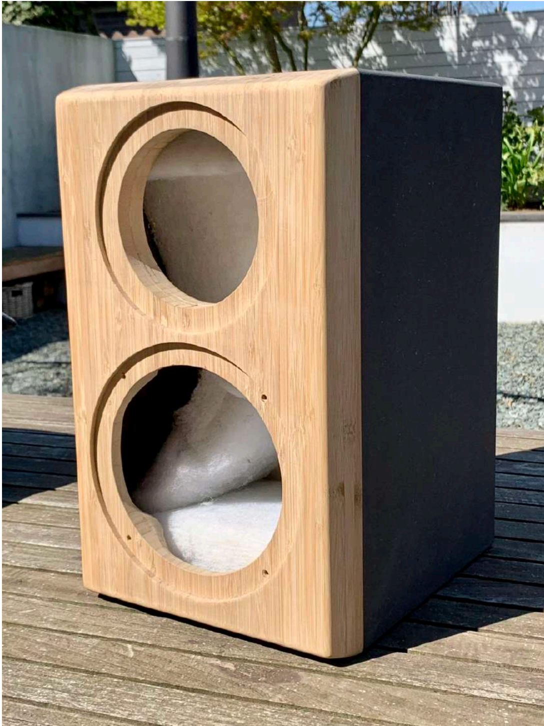
Figuur 71 Zo ziet de kast eruit met bamboe front. Het bamboe front is 15 graden afgeschuind, vonden we optisch iets mooier en was ook noodzakelijk omdat de afkant frees wat heeft gehapt. Wel heel lang moeten schuren ;-).
