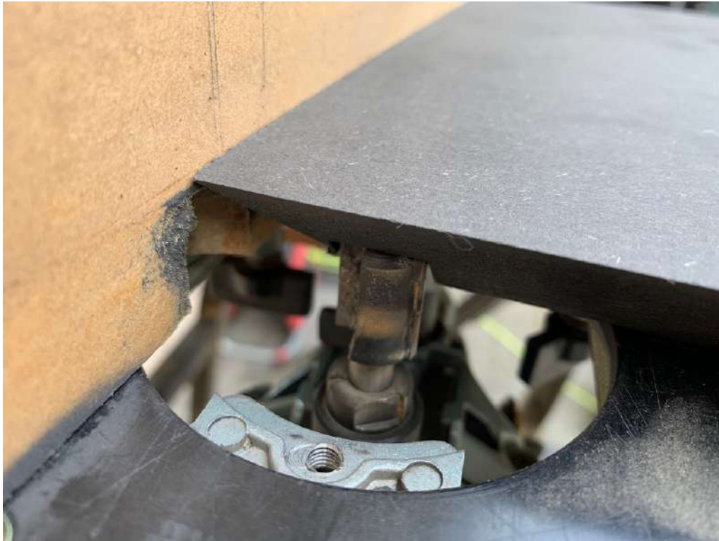
Figuur 2 De geleiding van een sleuf frezen in actie.
