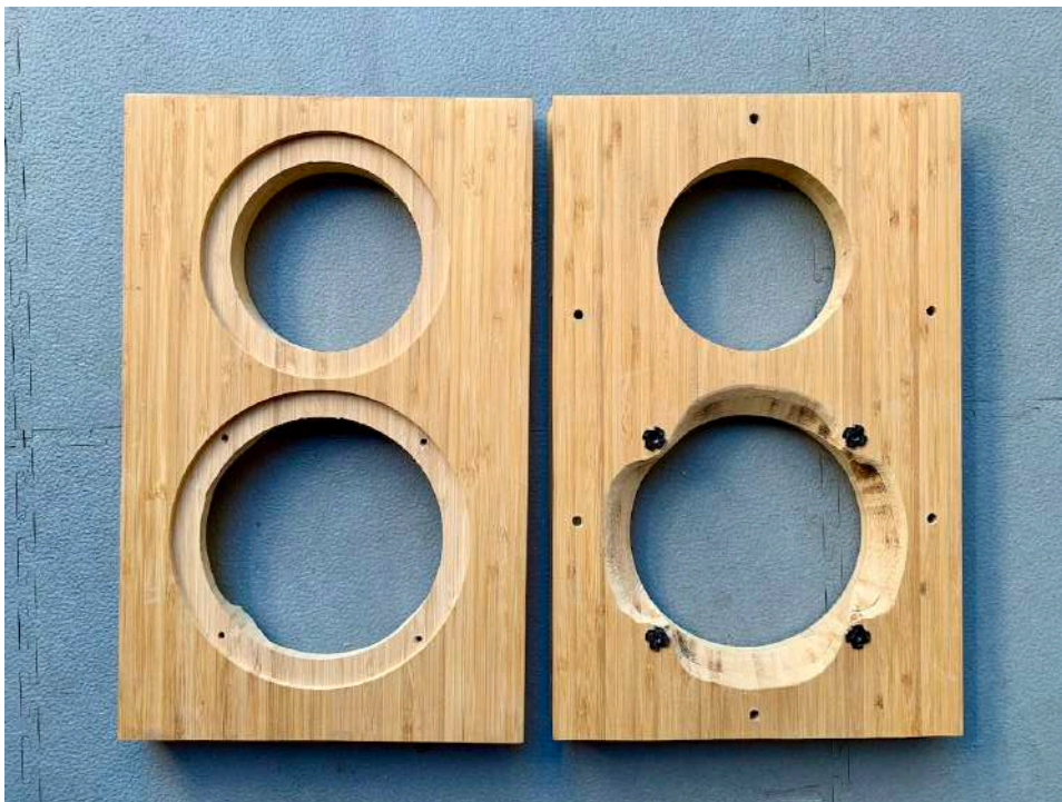
Figuur 33 Resultaat van het frezen, er is ook de nodige chamfer aangebracht bij de woofer aan de achterzijde..
