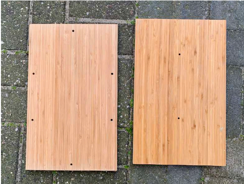
Figuur 22 Front wordt met duvels op kast gefixeerd, zodat die bij lijmen niet kan verschuiven. Dus op een plank zijn hiervoor al gaten geboord. In de ander is gat geboord voor middelpunt om drivers uit te frezen.
