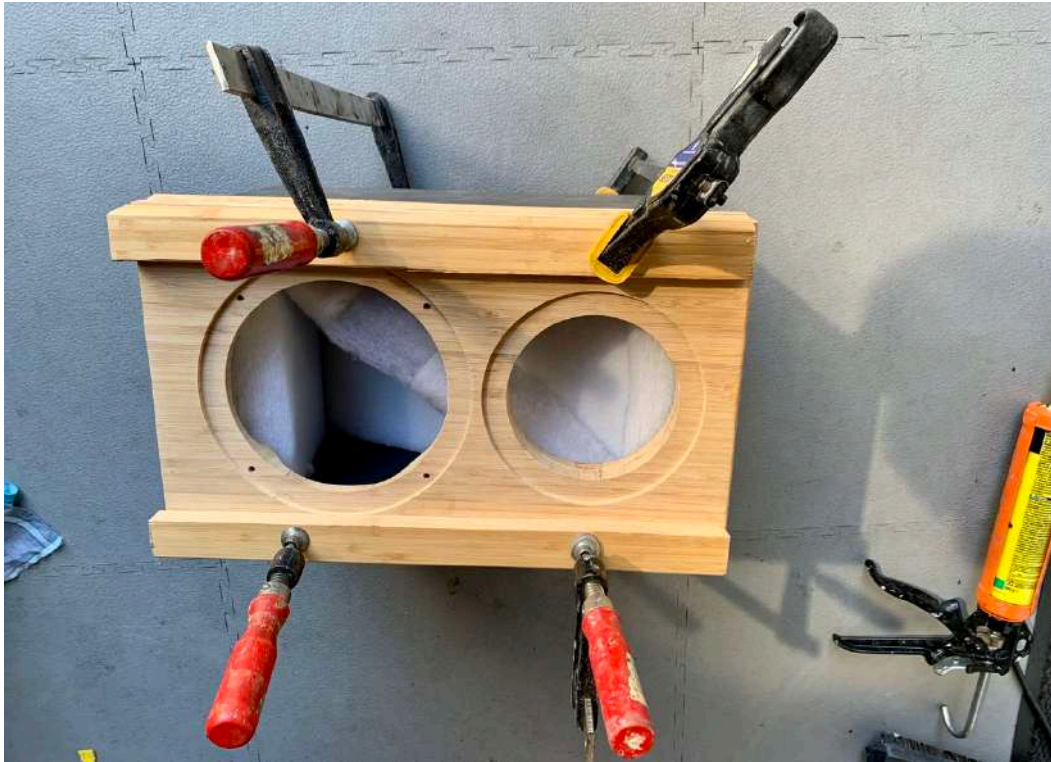
Figuur 65 Front wordt op kast gelijmd, de 6 duvels houden front op de juiste plaats en met lijmklemmen wordt er druk uitgeoefend.
