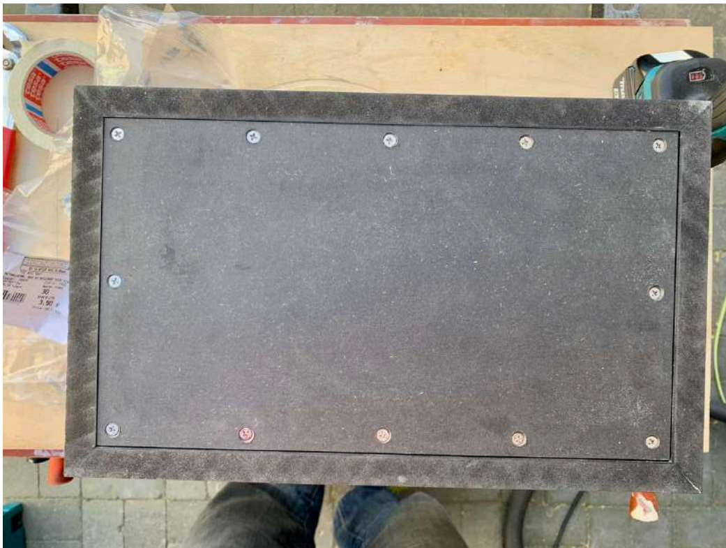
Figuur 70 De achterwand kan er vervolgens ingeschroefd worden. De binding posts zijn nog niet aangebracht, hiervoor zijn twee 7 mm gaten nodig.
