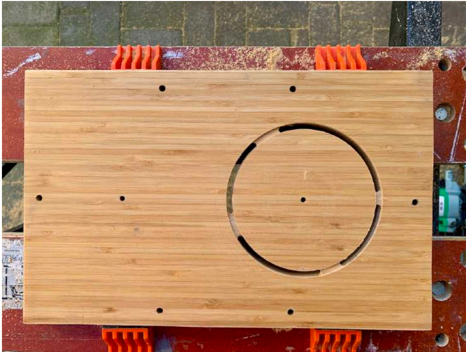
Figuur 32 Laatste stukken worden even met decoupeerzaag gedaan, omdat anders het middelpunt niet meer gefixeerd is.
