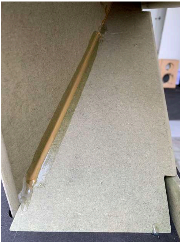
Figuur 38 Uitgehard is woodmax een enorm sterke lijm, de aanhecht kracht in begin is niet voldoende om plankje op zijn plaatst te houden. Met lijmpistool even een wat smeltlijm aangebracht om plankje op zijn plek te houden. Even aanbrengen vasthouden en wachten tot lijm afgekoeld is.
