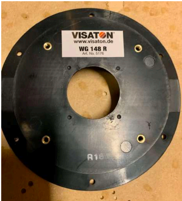
Figuur 10 De positie van de gaten is overgenomen. Met kolomboor met 6mm boor het gat overnemen en iets inboren.
