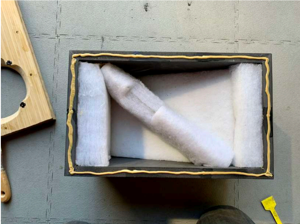
Figuur 64 Lijm aanbrengen, wat in gaten smeren en uitsmeren over rand.
