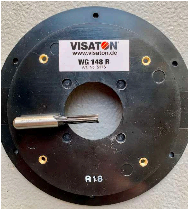
Figuur 12 De schroeven waarmee frontplaat van tweeter vast zit, kunnen nu verzinken in de waveguide.
