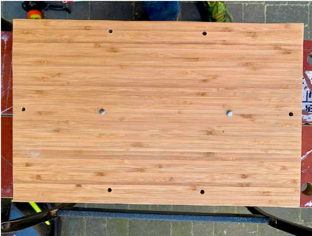
Figuur 25 De gaten als middelpunt voor frezen drivers, zijn nu ook overgenomen in de achterste bamboe snijplank, door hier twee pinnen door te doen tijdens lijmen, kunnen ze niet meer wegdraaien. t.o.v. elkaar.
