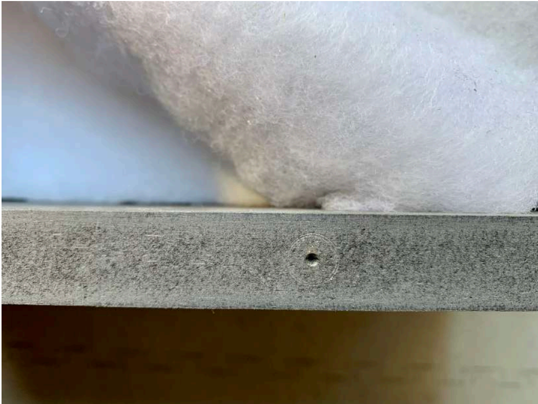
Figuur 63 Zo zie je dus waar je gat voor duvel moet boren.
