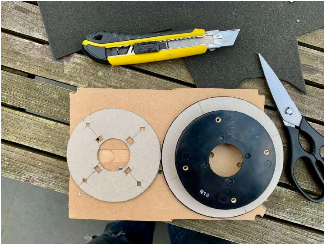
Figuur 72 Wat dun grijs schuim wordt gebruikt, om de kleine ruimte tussen tweeter en waveguide op te vullen. Eerst even van karton een mal gemaakt.
