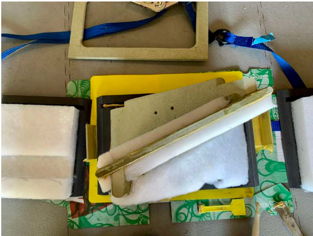
Figuur 52 De brace wordt in schuine sleuf in linker zijwand geplaatst.
