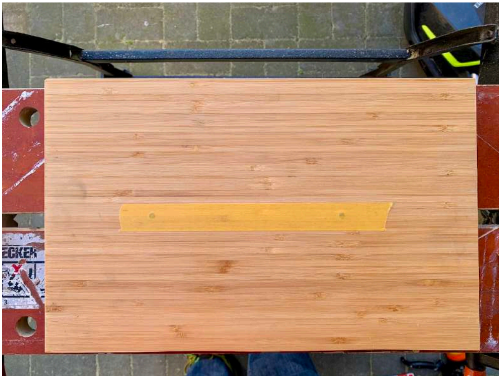
Figuur 29 Afplakken met tape, want er komt een plank overheen om de druk van de lijmklemmen te verdelen en er kan dus lijm uit gat komen en de aandrukplank moet hierdoor niet vastgelijmd worden.
