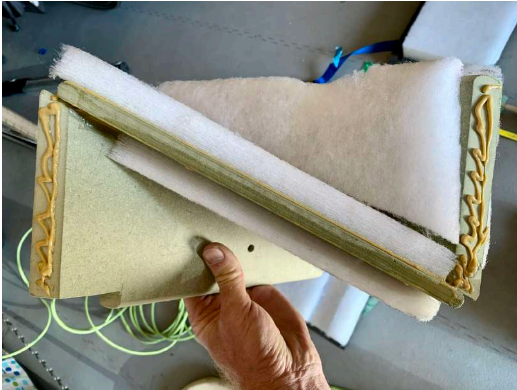
Figuur 51 De schuine kant van flap heeft wat speling dus ruim voorzien van lijm, deze komt op de linker zijwand.
