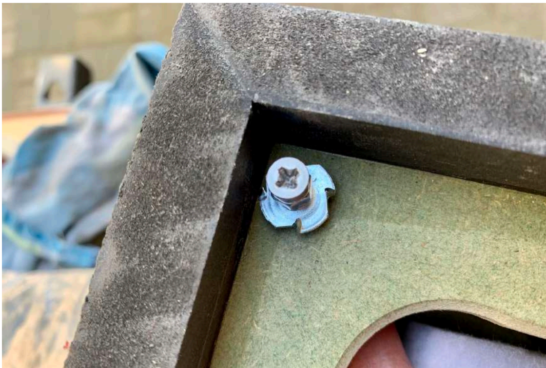
Figuur 68 Inslagmoer onder aanbrengen en van bovenaf met een schroef in het hout van achterschot trekken.
