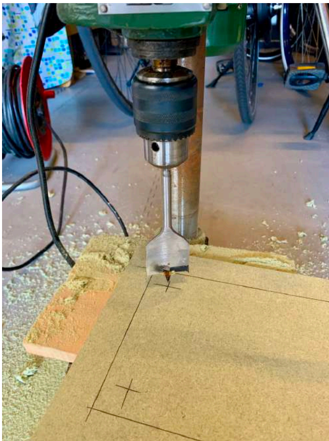
Figuur 17 Boren van de gaten in achter tussenschot, dit schot komt in een gefreesde sleuf in zij en boven en onderkant. Het houdt deze kanten bij elkaar en achterwand wordt hier tegenaan geschroefd.
