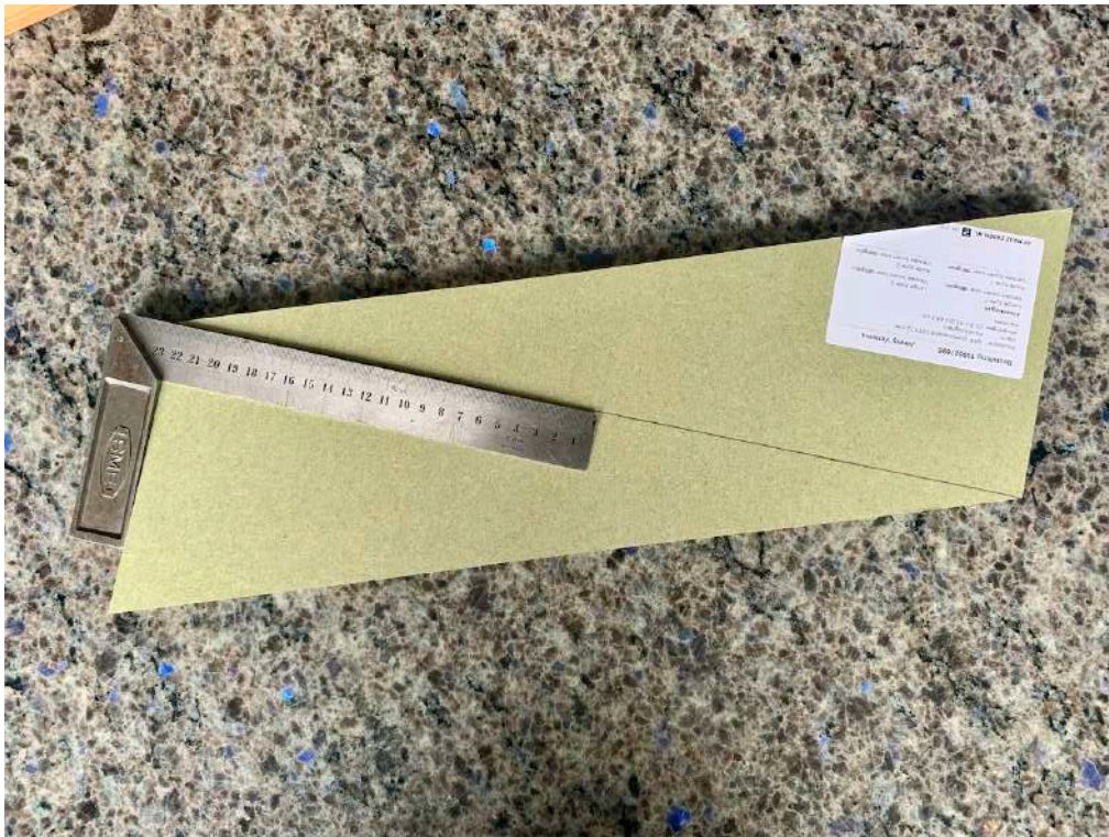
Figuur 15 Vanwege de kosten zijn twee flappen als een parallellogram besteld. Deze moet in tweeën gezaagd worden.
