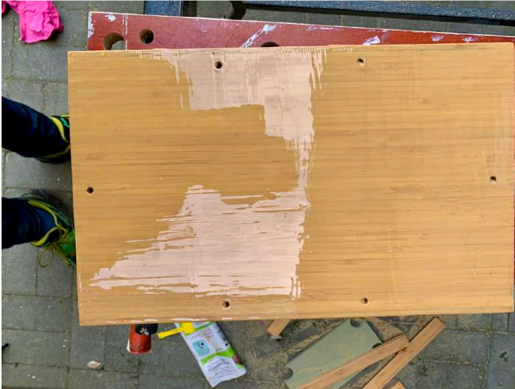
Figuur 24 En dit uitgesmeerd, bleek dat met lijklemmen erop, de twee planken gemakkelijk wilde verdraaien, dus dat vervolgens anders aangepakt.
