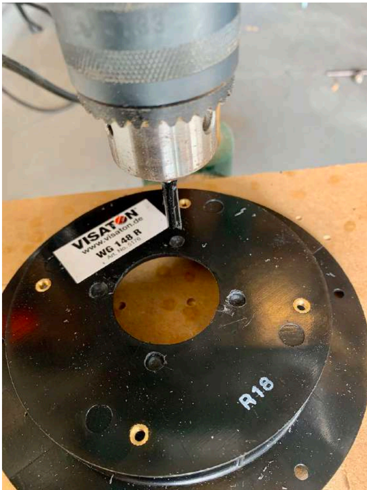
Figuur 11 Met 6 mm frees de gaten vlak maken en voldoende diep.
