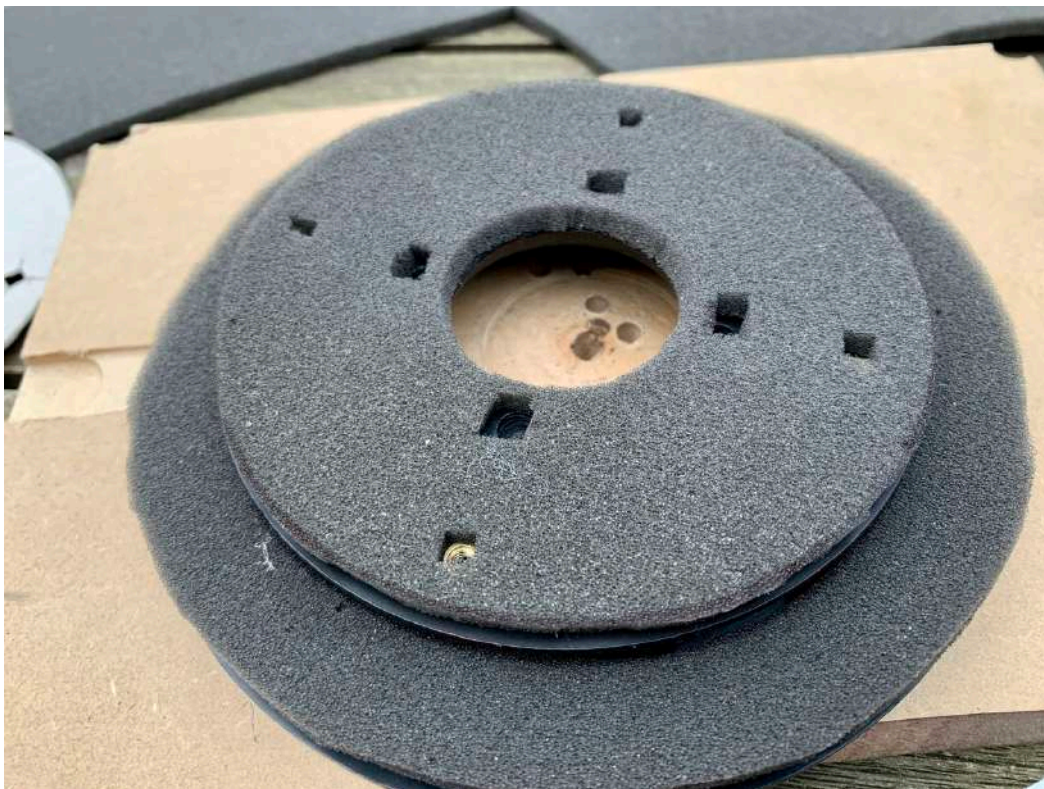
Figuur 73 En zo ziet de stukken schuim er uiteindelijk uit. Dit schuim gebruik ik ook tussen waveguide en kast om af te sluiten. De zelfklevende foam die ik had, werd te dik, daarvoor had ik misschien 0,5-1 mm dieper uit moeten frezen.
