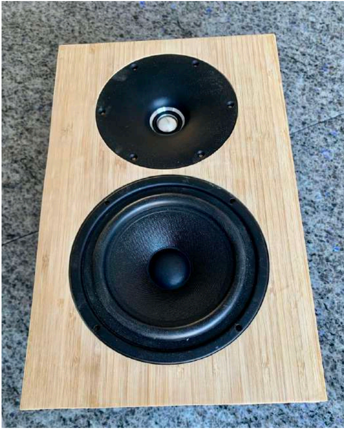
Figuur 41 De drivers in front geplaatst.
