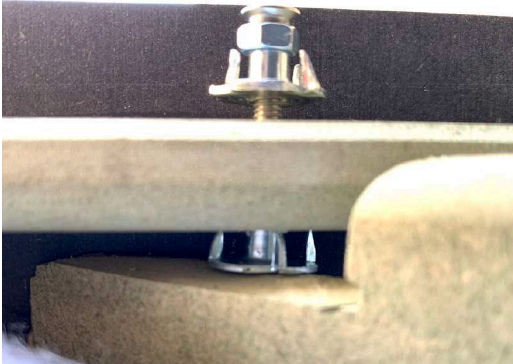
Figuur 69 o ziet het ervan opzij uit, om de inslagmoer aan te brengen en in achterschot te trekken.
