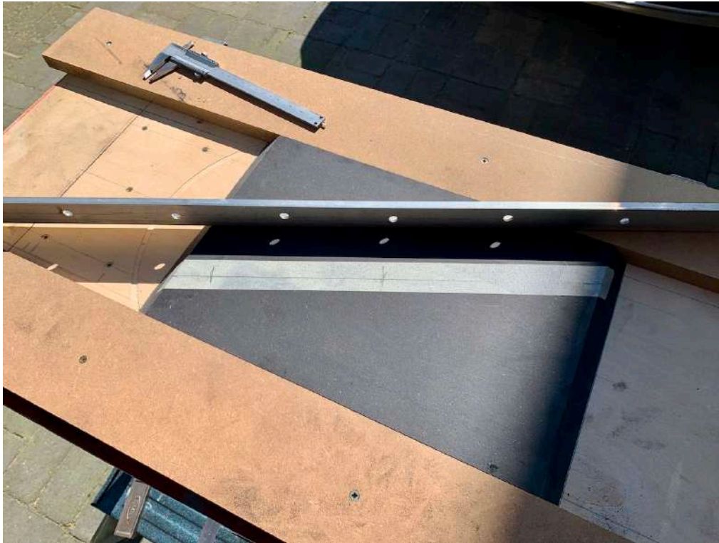
Figuur 20 Het frezen van de schuine sleuf voor de brace. De zijkant is ingeklemd tussen twee stukken MDF waarop een aluminium hoekprofiel als geleide wordt gebruikt. Borg werkstuk zodat die niet kan verschuiven, b.v. met duct tape.
