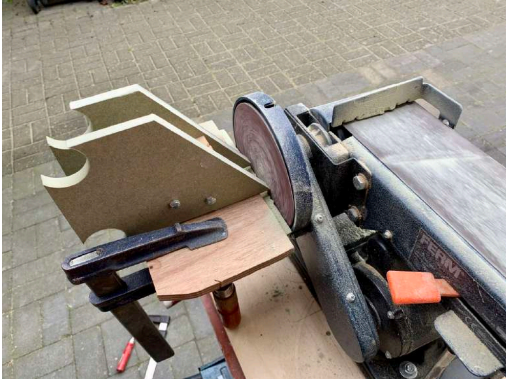
Figuur 34 Even een hulpstuk gemaakt uit resthout, om juiste hoek af te schuiven. Hoek is 54 graden, de maximale hoek bij opmaatzagen is 46 graden, wat te weinig is, dus laatste stukje moet geschuurd worden.
