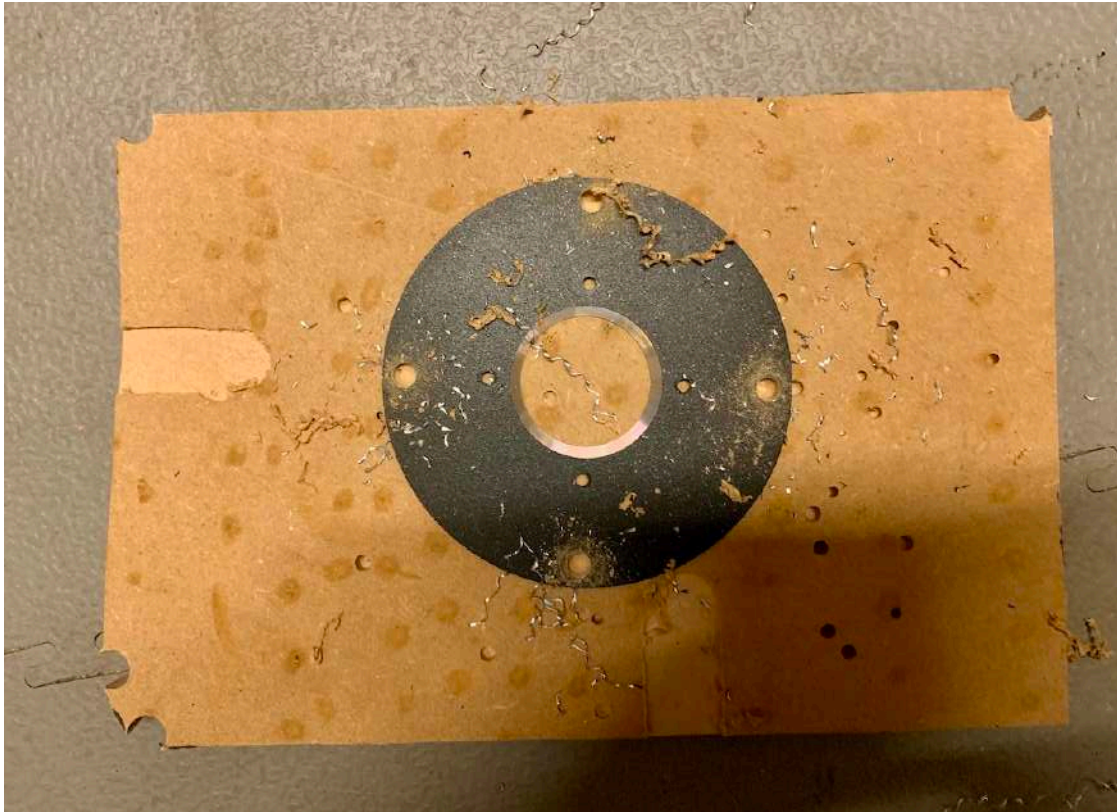
Figuur 8 De schroefgaten op waveguide staan net iets verder uit elkaar dan die op de tweeter. Door de gaten op te boren van 4 naar 6 mm gaat het passen.
