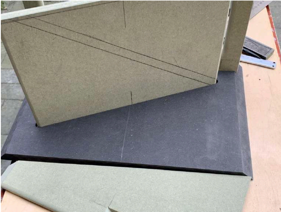
Figuur 37 De plaatst van de flap op schuine brace is afgetekend, Binnen de lijnen dus bison woodmax aanbrengen. Breng geen lijm aan bij de uiteinden, want het is niet de bedoeling dat het per ongeluk vastgelijmd wordt aan het zwarte MDF.
