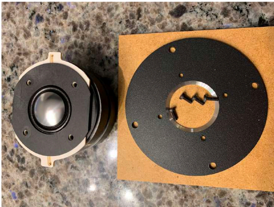
Figuur 7 De aluminium frontplaat is eenvoudig van te tweeter te verwijderen, 4 schroeven moeten met inbus verwijderd worden.
