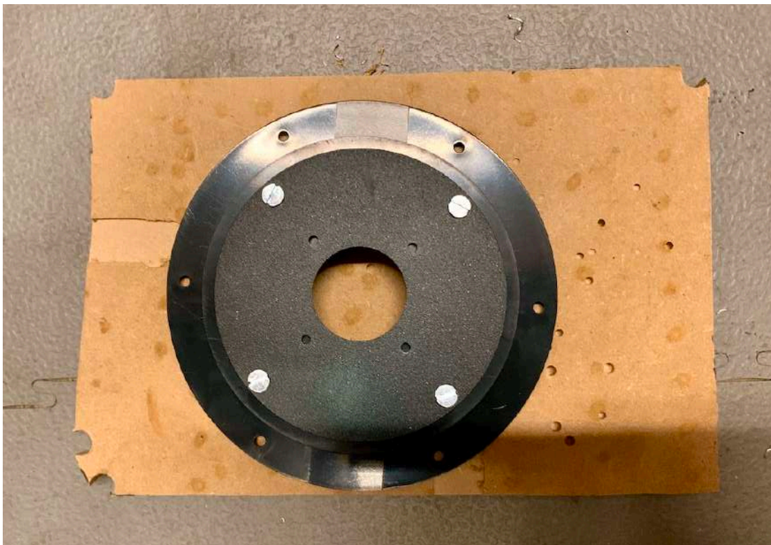
Figuur 9 De plaat van de tweeter kan nu op de waveguide geschroefd worden en de positie van de andere 4 gaten worden overgenomen.
