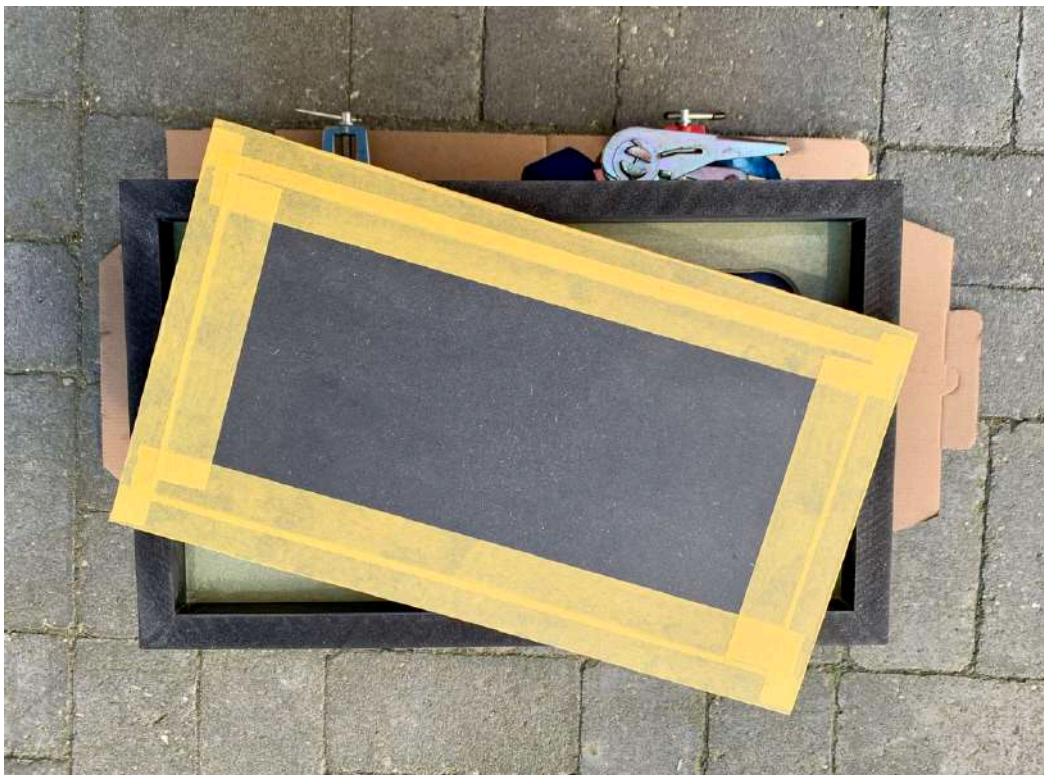
Figuur 60 Plak achterwand af met glad schilders tape, zodat die niet per ongeluk vastgelijmd wordt.
