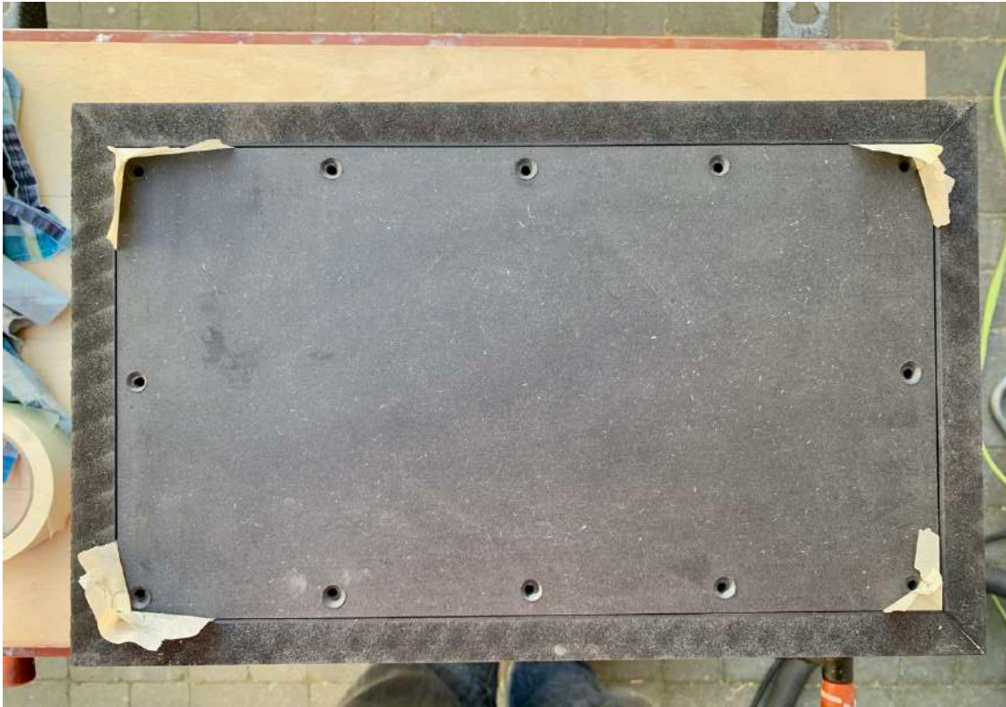
Figuur 67 De achterwand heeft rondom 0,5 mm speling. Door op de hoeken twee laagjes schilders tape aan te brengen, gaat hij mooi in het midden liggen en kun je de gaten overnemen met 4 mm boor. Daarna gaten in achterschot opboren met 5 mm voor aanbrengen inslagmoer. De gaten in achterwand blijven 4 mm!
