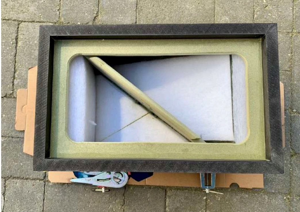
Figuur 59 Met een klein plamuurmes kun je alle lijm wegsteken van achterschot. Poets de laatste lijmresten weg met b.v. Wasbenzine.
