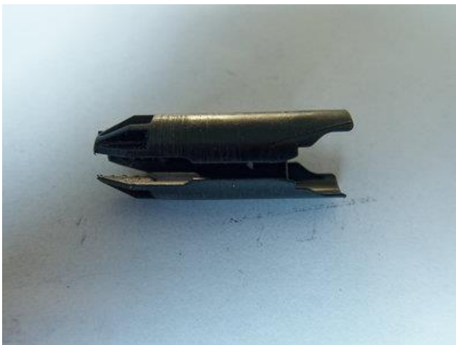
De klemkous, die in de gemaakte uitsparingen moet passen
