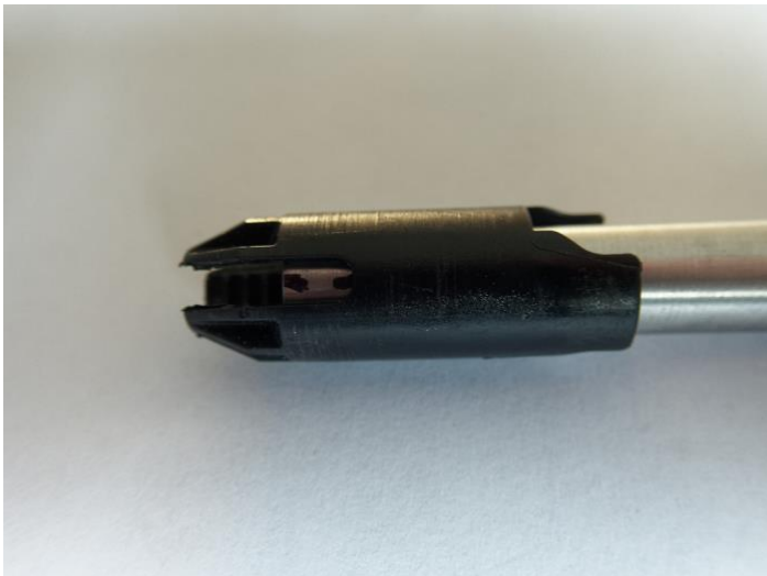
Als je 120 graden draait zie je afteken streep en kun je de volgende streep aftekenen.
