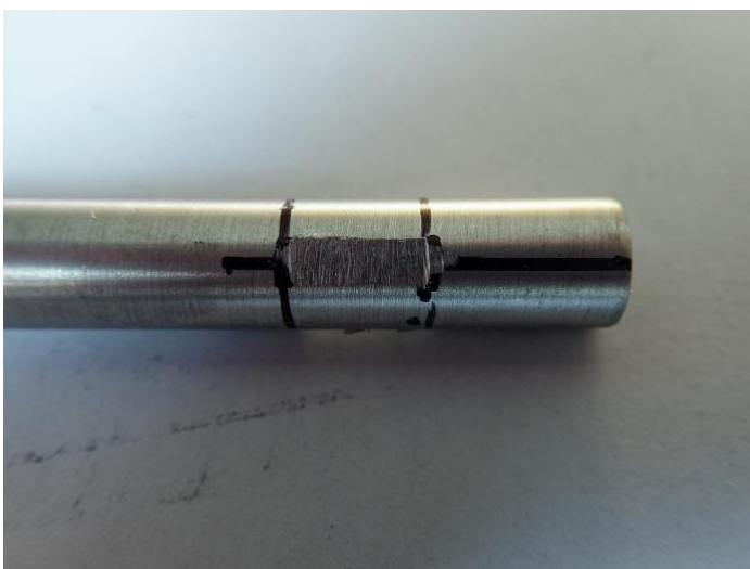
Op je juiste plaats wat afvijlen om plat te maken, boren gaat hierdoor makkelijker.
