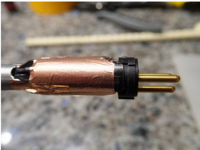
Aanbrengen van koperfolie ter afscherming, deze is met wat soldeer verbonden met aarde van XLR plug. De kleine strookje koperfolie, zorgen ervoor dat aluminium buis ook verbonden is met aarde.
