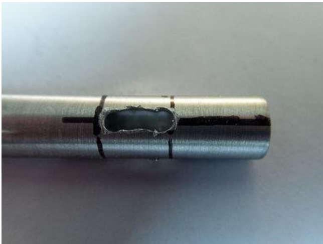
De gaten met elkaar verbinden, boor zijwaarts met wat kracht te verplaatsen.
