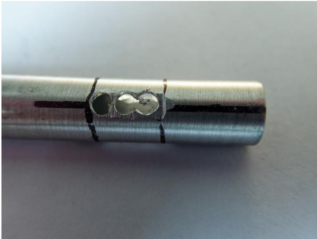
Het boren van 3 gaten van 3mm.
