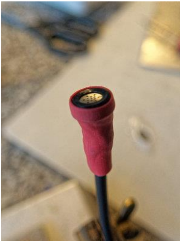
En weer krimpkous. zodat rubberen ring blijft zitten. Totale dikte is nu voldoende, zodat dit zelf klemvast gaat zitten in buis.
