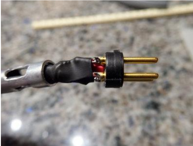
Krimpkous, om de onderdelen heen, zodat die geen kortsluiting kunnen maken, met aluminium buis.
