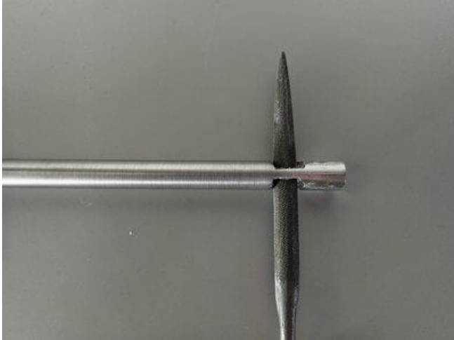
Verder kan er ook gevijld worden, totdat de klemkous netjes past.
