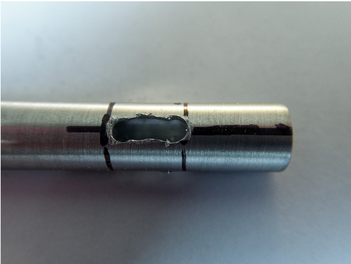
Figure 20: De gaten met elkaar verbinden, boor zijwaarts met wat kracht te verplaatsen.
