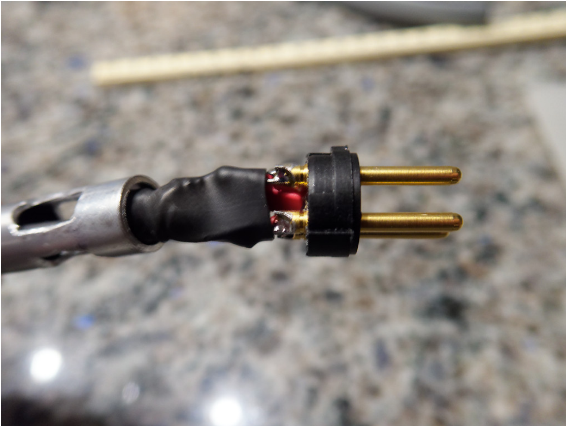
Figure 31: Krimpkous, om de onderdelen heen, zodat die geen kortsluiting kunnen maken, met aluminium buis.
