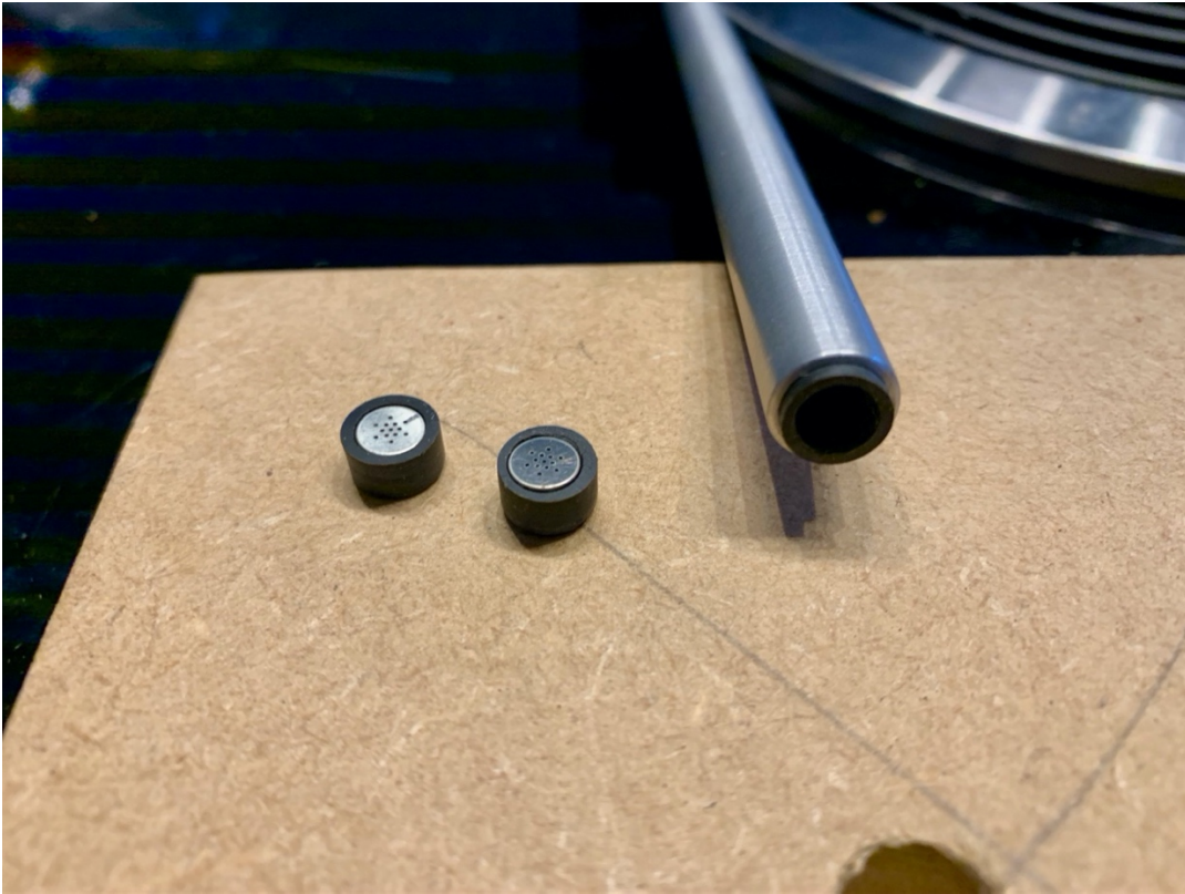
Figure 7: De uitgeboorde plastic busjes met microfoonkapsel er los in en controle of plastic bus goed klem past in buis.
