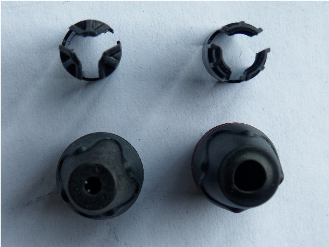
Figure 25: Links de standaard Thule en klemkous, rechts de versie voor dikker snoer. De standaard klemkous van links wordt gebruikt, met de Thule van rechts, zodat aluminium buis erdoor past.
