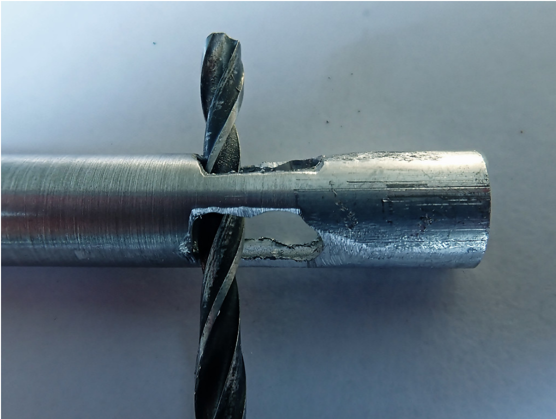
Figure 21: Als alle drie de uitsparingen er zijn, dan kunnen ze groter gemaakt worden, door draaiende boor, door twee uitsparingen tegelijk heen en weer te bewegen. Eerst 3mm boor, dan 4mm boor.
