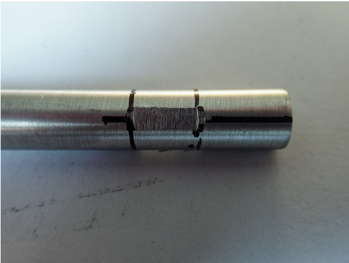
Figure 18: Op je juiste plaats wat afvijlen om plat te maken, boren gaat hierdoor makkelijker.
