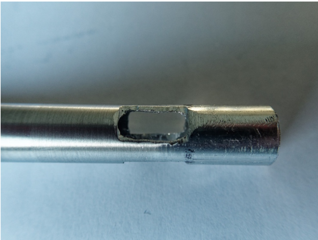
Figure 12: We moeten drie uitsparingen maken, zodat klemkous, hierin valt.
