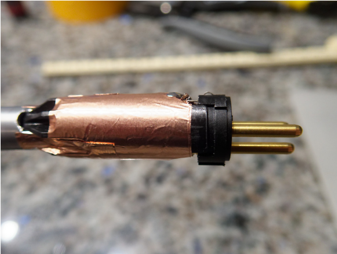
Figure 33: Aanbrengen van koperfolie ter afscherming, deze is met wat soldeer verbonden met aarde van XLR plug. De kleine strookje koperfolie, zorgen ervoor dat aluminium buis ook verbonden is met aarde.
