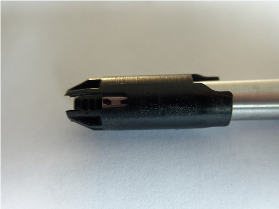
Figure 17: Als je 120 graden draait zie je afteken streep en kun je de volgende streep aftekenen.
