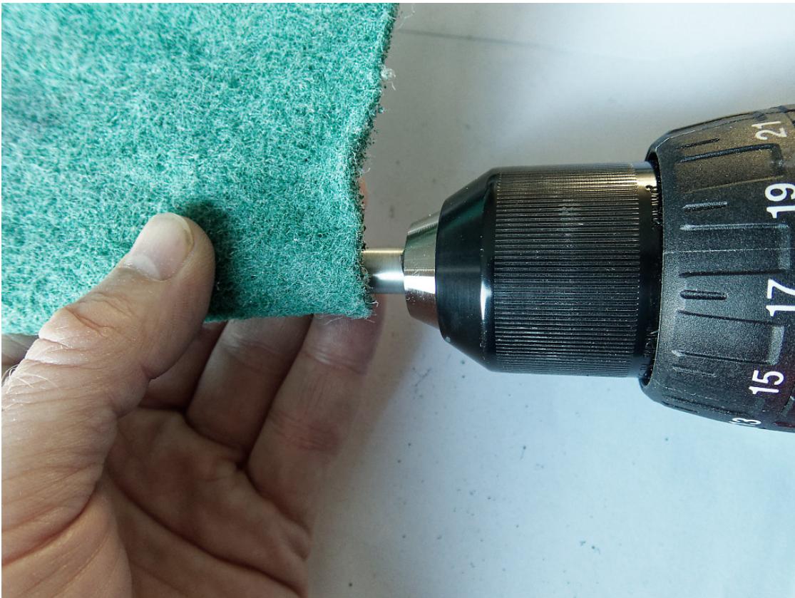
Figure 26: De aluminium buis kun je in boormachine plaatsen en met 400-600 schuurpapier en schuurmatje een mooi geborsteld uiterlijk geven.
