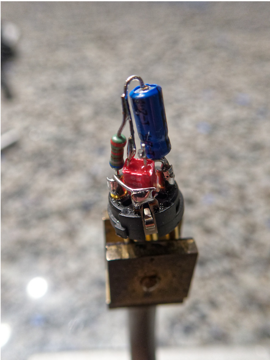
Figure 28: De overige onderdelen gemonteerd aan XLR plug.
