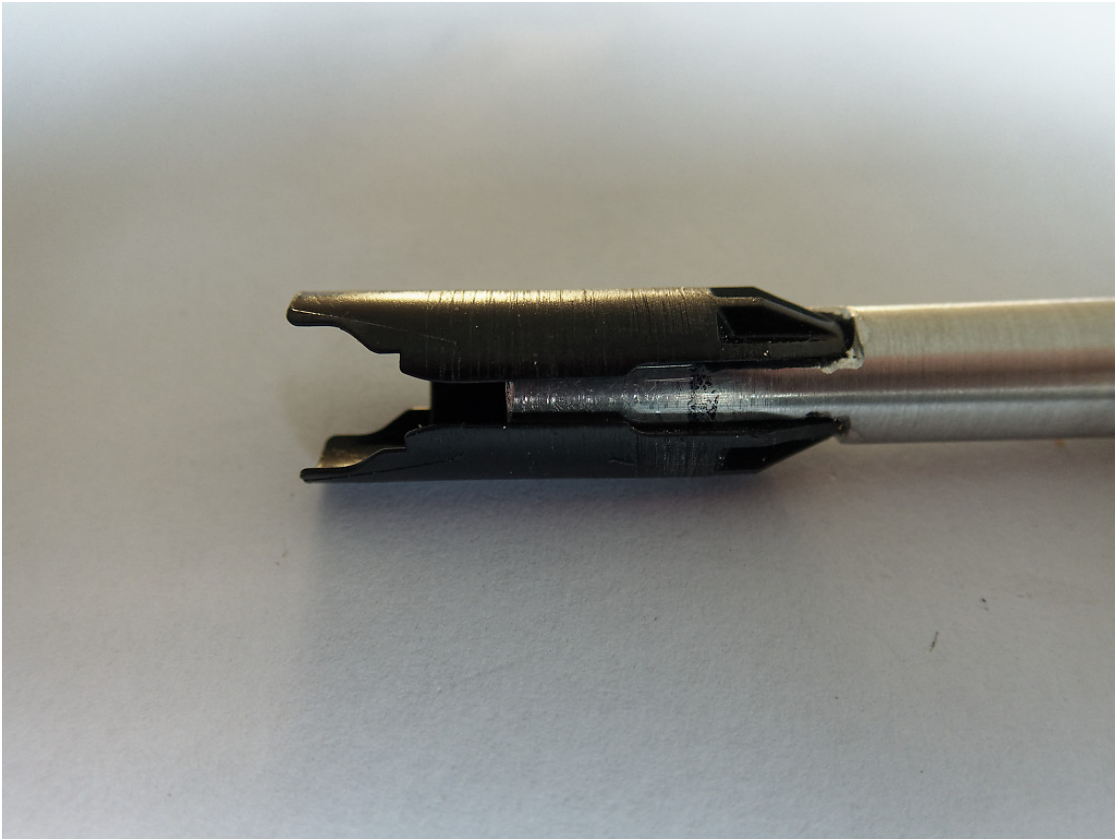
Figure 23: De klemkous past netjes in de uitsparingen.
