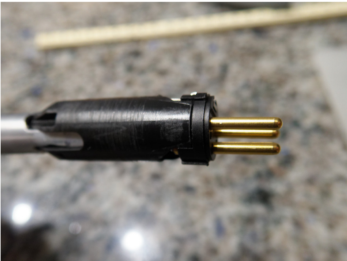
Figure 32: Plaatsen van de klemkous.
