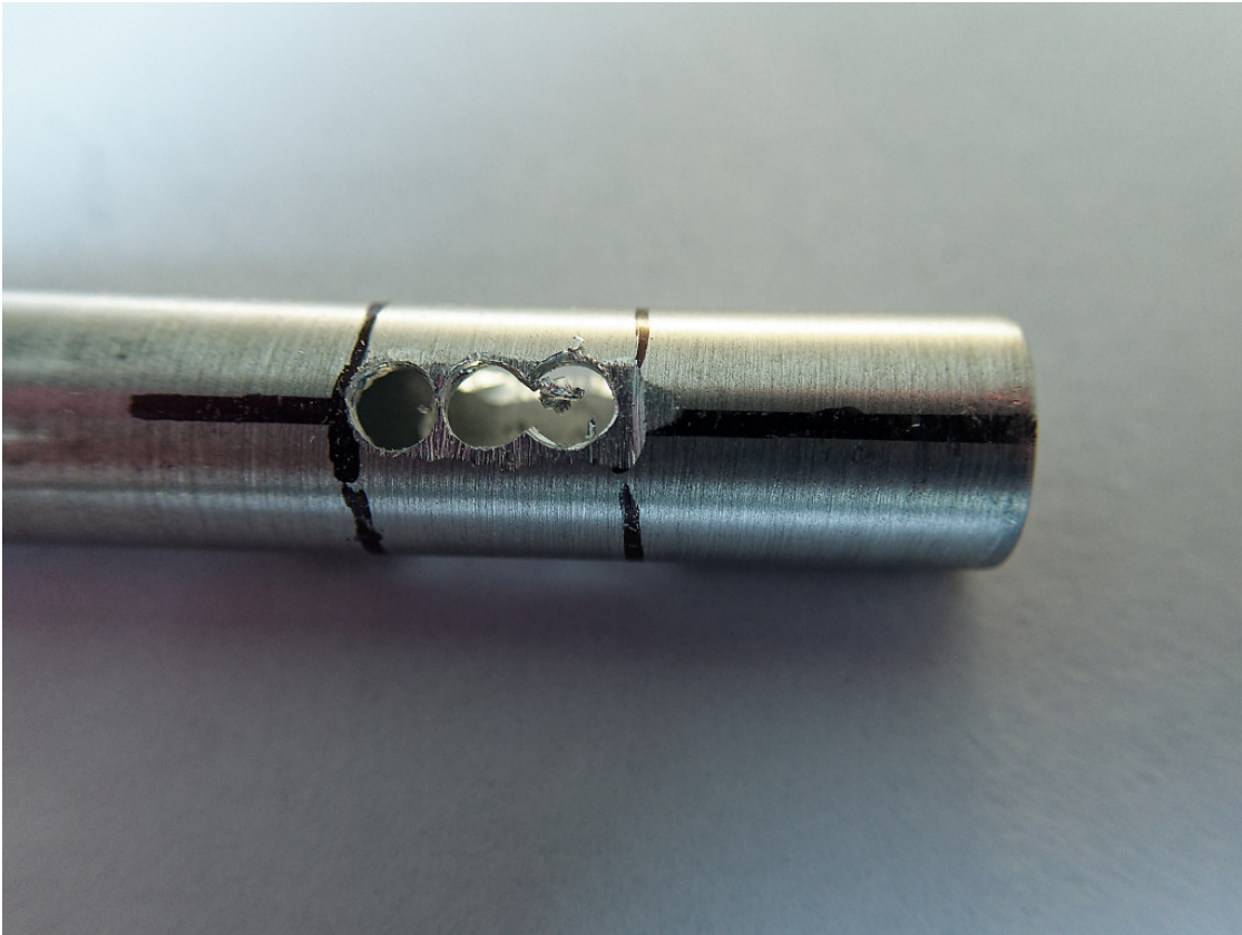
Figure 19: Het boren van 3 gaten van 3mm.
