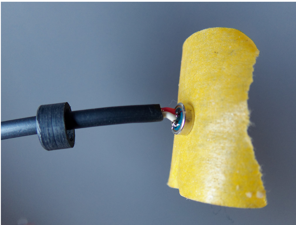
Figure 10: Plak microfoonkapsel af met tape ter bescherming en doe bewerkt plastic busje om kabel.
