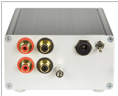
Figuur 8. De plaatsing van de aansluitbussen en schakelaar op het achterpaneel.
