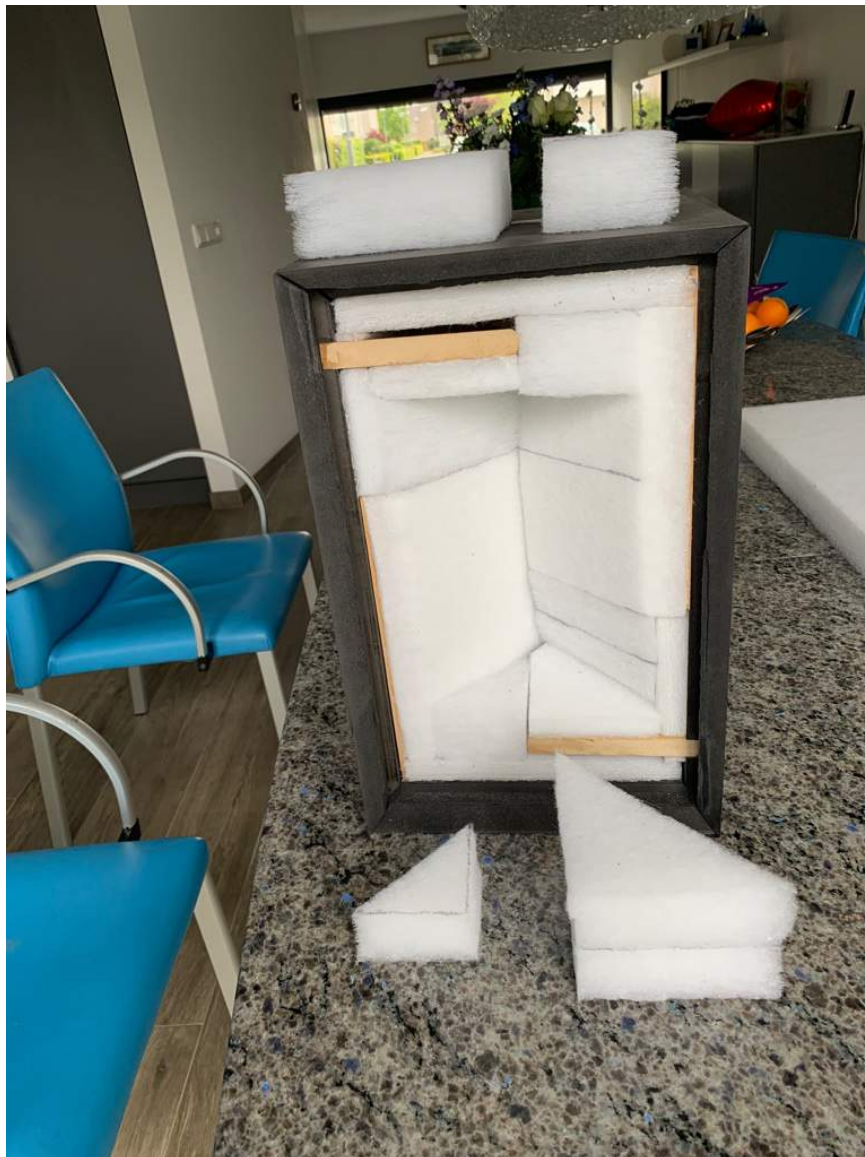
Figuur 23 Indruk van de driehoeken 20kg/m 3 dempingsmateriaal dat wordt aangebracht
