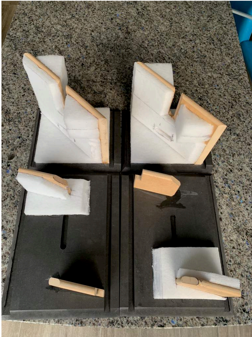
Figuur 21 Aanbrengen van dempingsmateriaal
