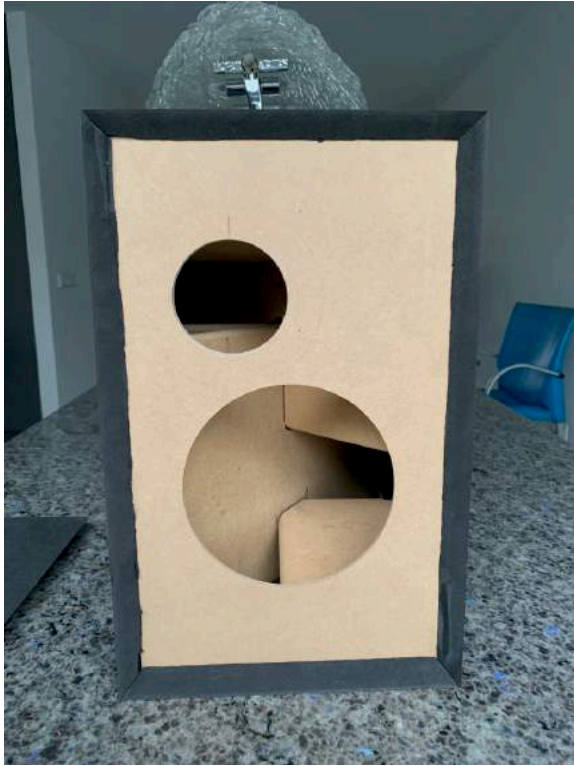
Figuur 19 Voorkant met voorschot en met het uiteindelijke front panel ertegen
