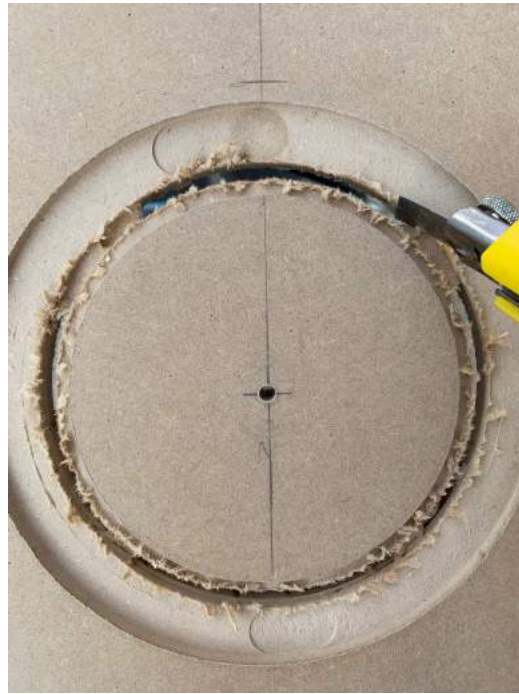
Figuur 7 Zorg dat binnenkant verbonden blijft met buitenkant en snij laatste stukjes los.
