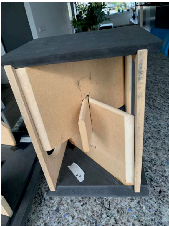
Figuur 18 Inkijk zijkant en achterkant maar nu zijn voor en achterschot met juiste uitsparingen geplaatst
