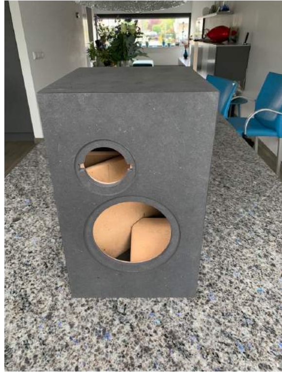
Figuur 19 Voorkant met voorschot en met het uiteindelijke front panel ertegen
