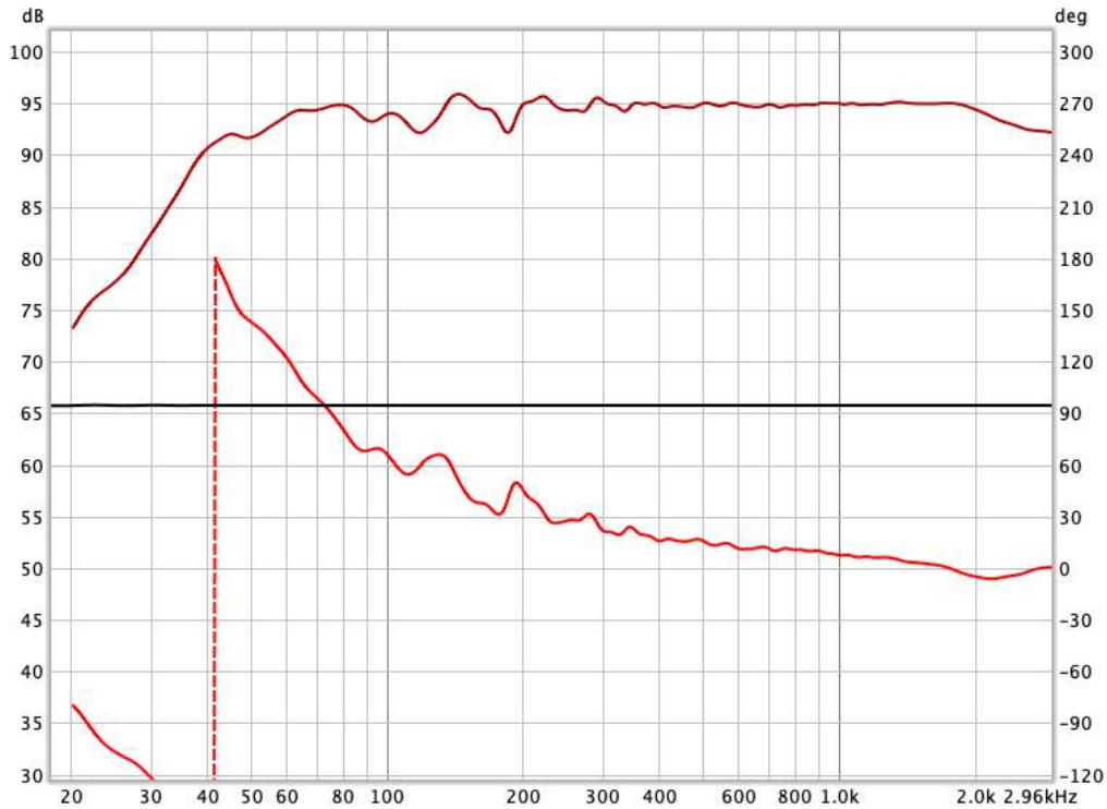
Figuur 58 Het 5.5ms window van de meting verwijderd, effecten van reflecties zijn zichtbaar maar geeft beter beeld fase verloop
