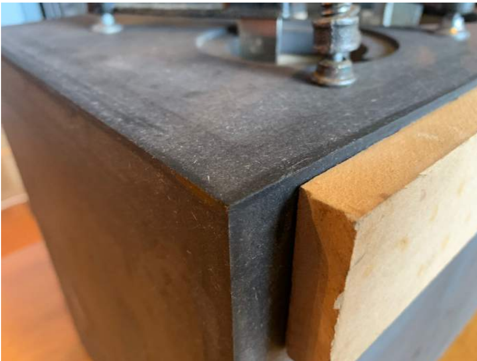
Figuur 2 Opname van een hoek waar drie panelen met een verstek van 45 graden bij elkaar komen.
