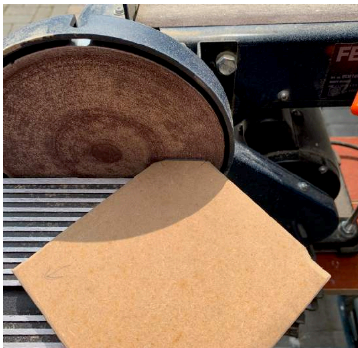
Figuur 16 Het aftekenen en op maat maken van de kleine schotten, zorg voor een paar tiende mm spelling bij proefpassen
