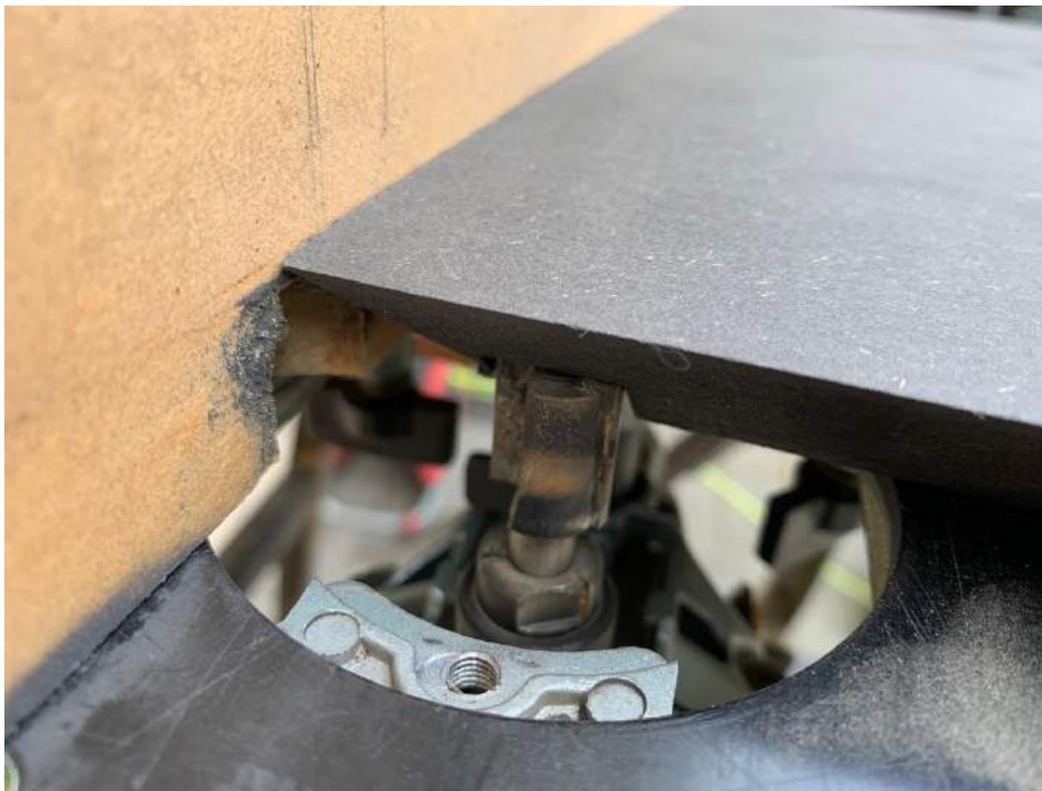
Figuur 4 De geleiding van een sleuf frezen in actie.
