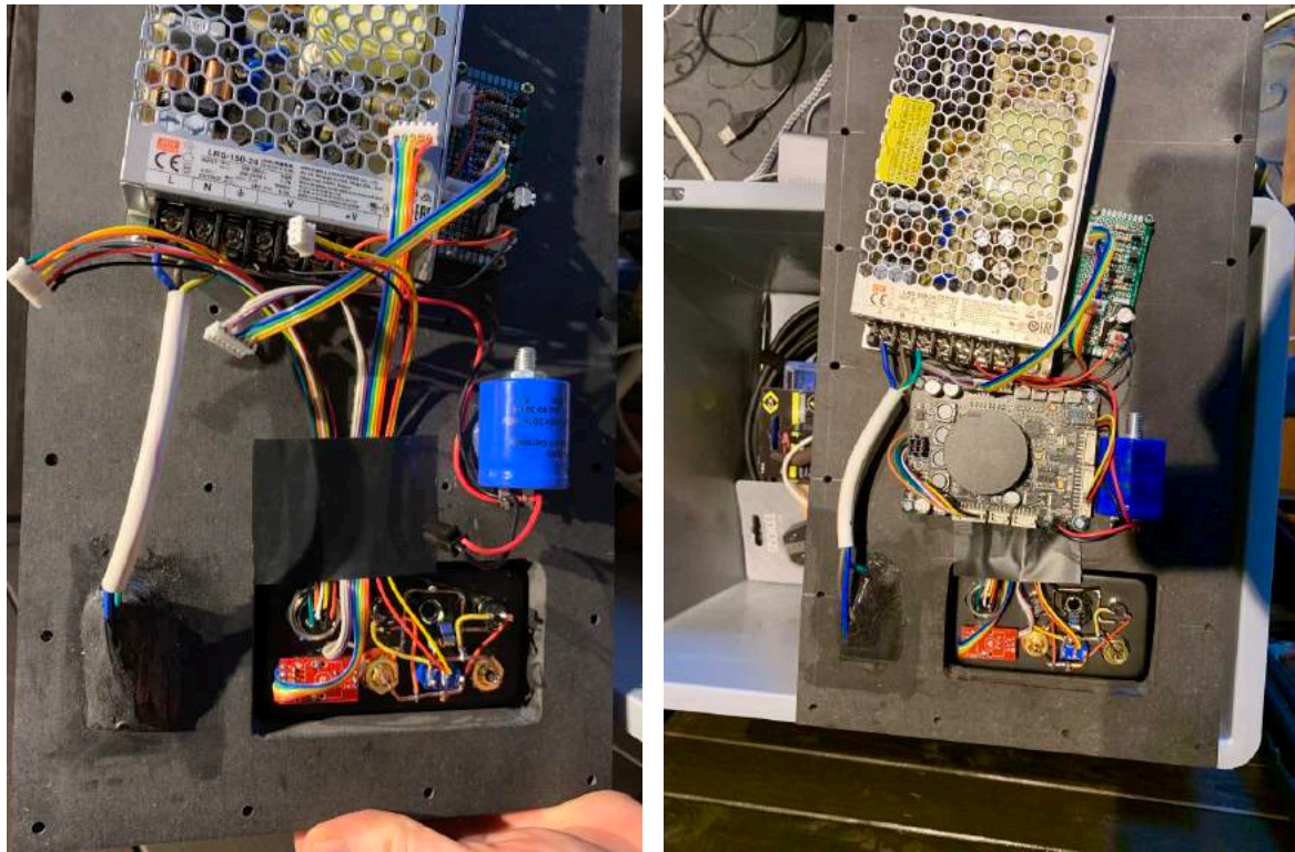
Figuur 28 Het achter paneel met voeding, versterkerboard en de aansluitingen.
