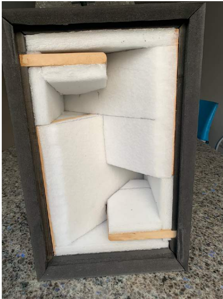
Figuur 22 Als de beklede panelen in elkaar gezet worden komt het er zo uit te zien
