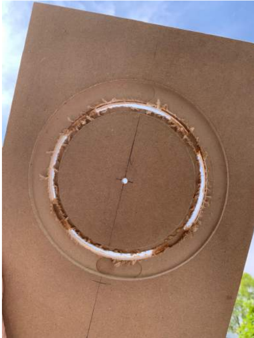
Figuur 7 Zorg dat binnenkant verbonden blijft met buitenkant en snij laatste stukjes los.
