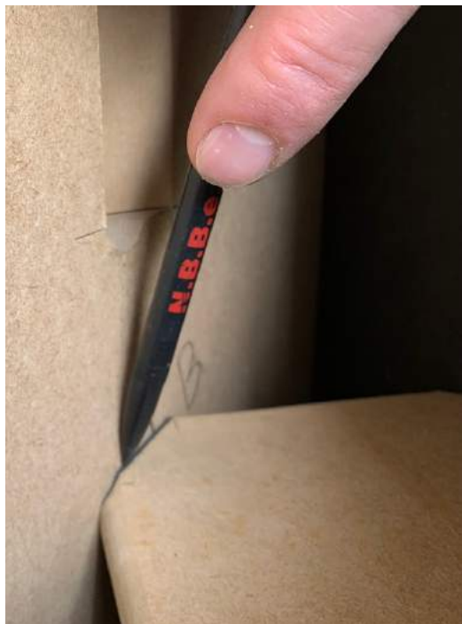
Figuur 16 Het aftekenen en op maat maken van de kleine schotten, zorg voor een paar tiende mm spelling bij proefpassen
