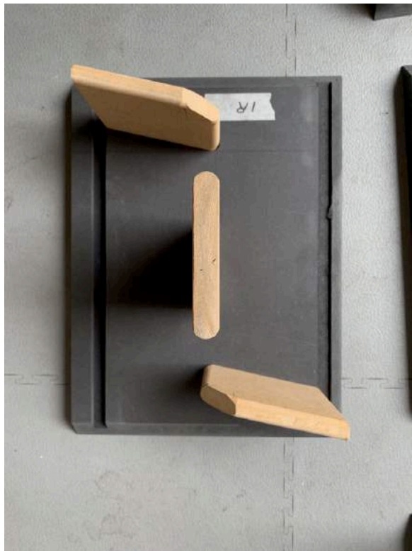
Figuur 15 Zijpaneel met schotten en onder/boven paneel met schot, daar waar kan rond afgewerkt.
