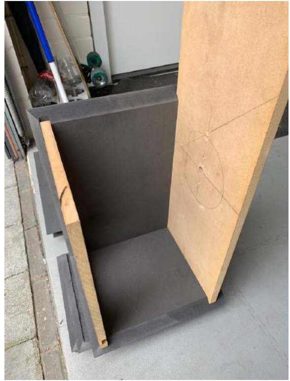
Figuur 12 Zijpaneel en onder/boven paneel en hoe deze panelen via sleuf en 16mm MDF verbonden worden.
