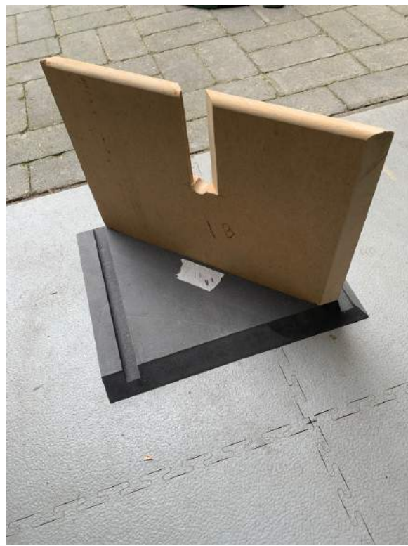
Figuur 15 Zijpaneel met schotten en onder/boven paneel met schot, daar waar kan rond afgewerkt.
