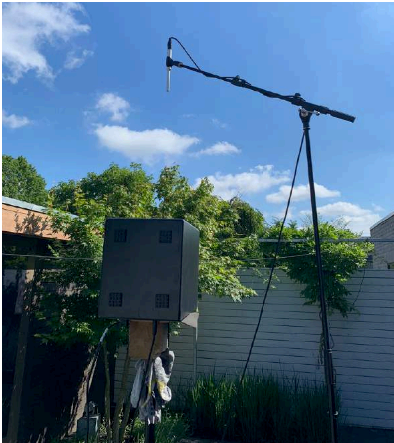
Figuur 42 De meetopstelling in de achtertuin, dit gaf me een mogelijke "gate" tijd van 5.5 ms
